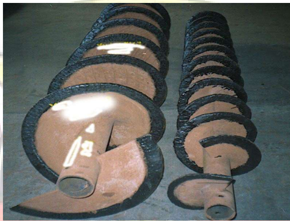
Gambar 1.2. Screw Conveyor Dengan Lapisan Hardfacing.
