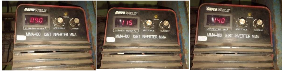
Lampiran 3 (c). Foto Pengaturan Arus Pengelasan.
