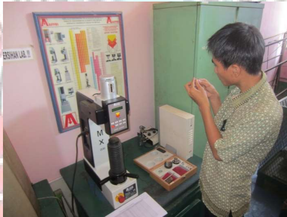
Lampiran 3 (g). Foto Saat Memilih Penetrator Pengujian Kekerasan.
