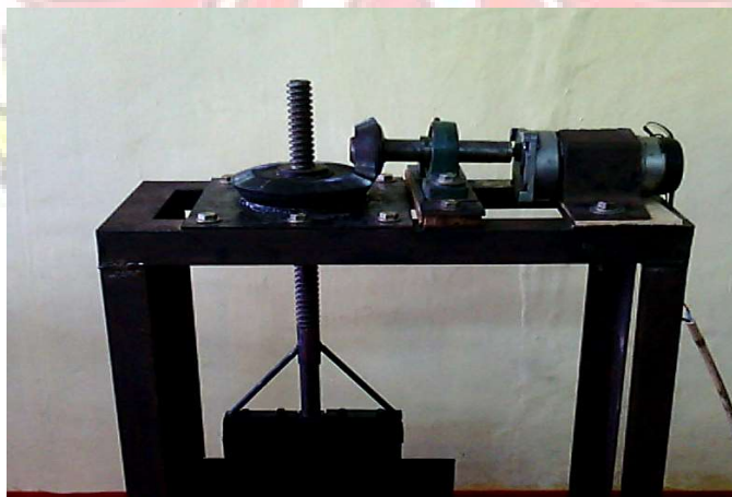
Gambar 21. Dudukan roda gigi ( bevel gear ) dan motor
