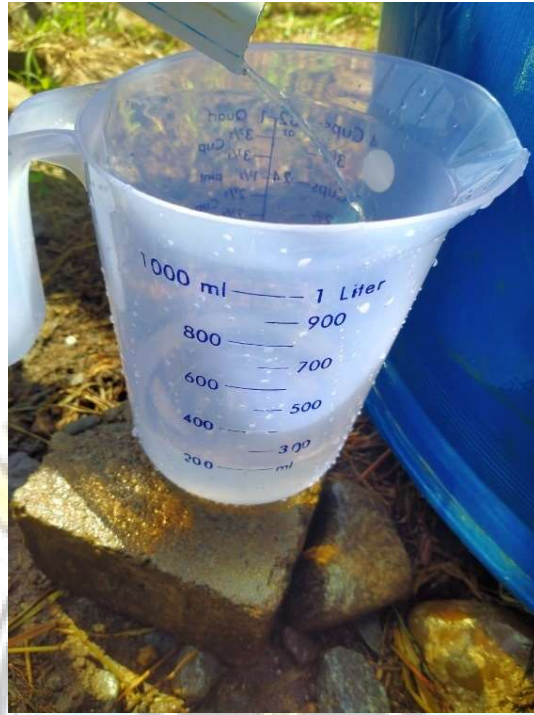
Pengambilan Data dan Perhitungan Debit Air
