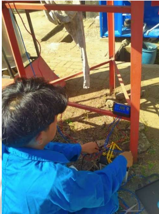
Pengukuran Tegangan Aki
