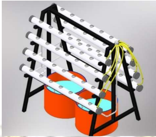
Gambar 3.4 Rangka Paralon Akuaponik Sumber: Mukhtar & Mihdar, 2022
