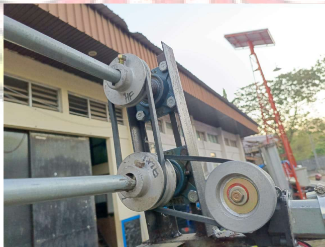
Gambar 4.4 Hasil Perakitan Mekanisme Atap Otomatis
