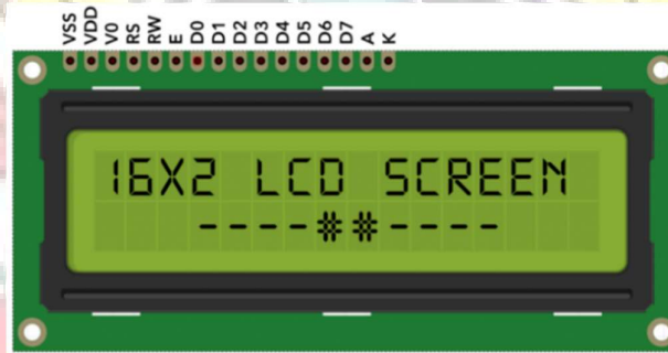
Gambar 2.14 LCD 16x2 Sumber: Natsir dkk, 2019
