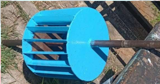
Gambar 4. 1 Turbin cross-flow dengan Bahan Plat
