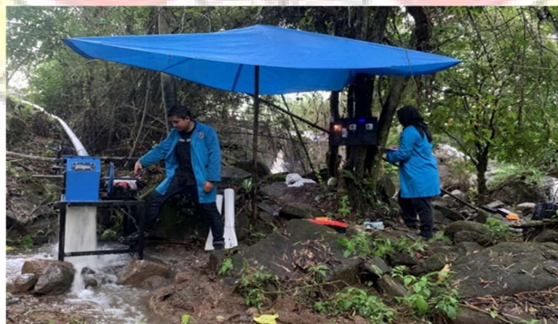
Gambar 4. 8 Pengujian PLTMH Kondisi Berbeban Sumber: Dokumen pribadi
