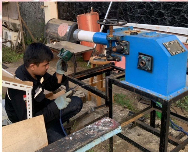
Gambar 2. Proses Pengelasan Dudukan Generator
