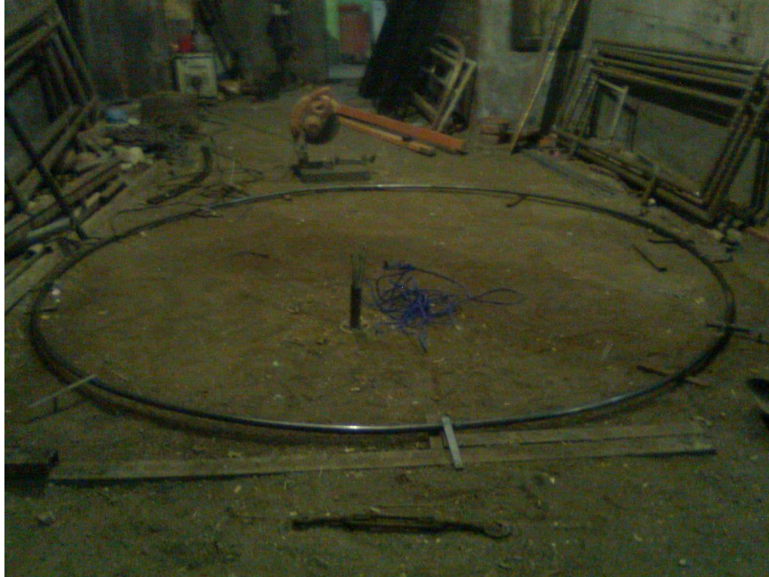
Gambar 4.5 Foto proses pembentukan lingkaran kincir
