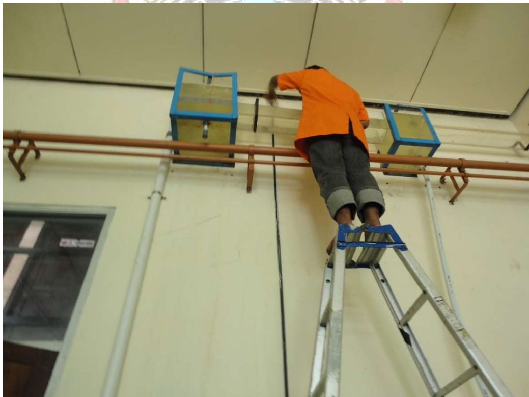
Gambar3. Pengukuran kecepatan aliran
