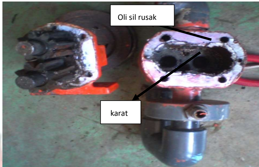
Gambar 3.3 Bodi pompa yang sudah karatan.
