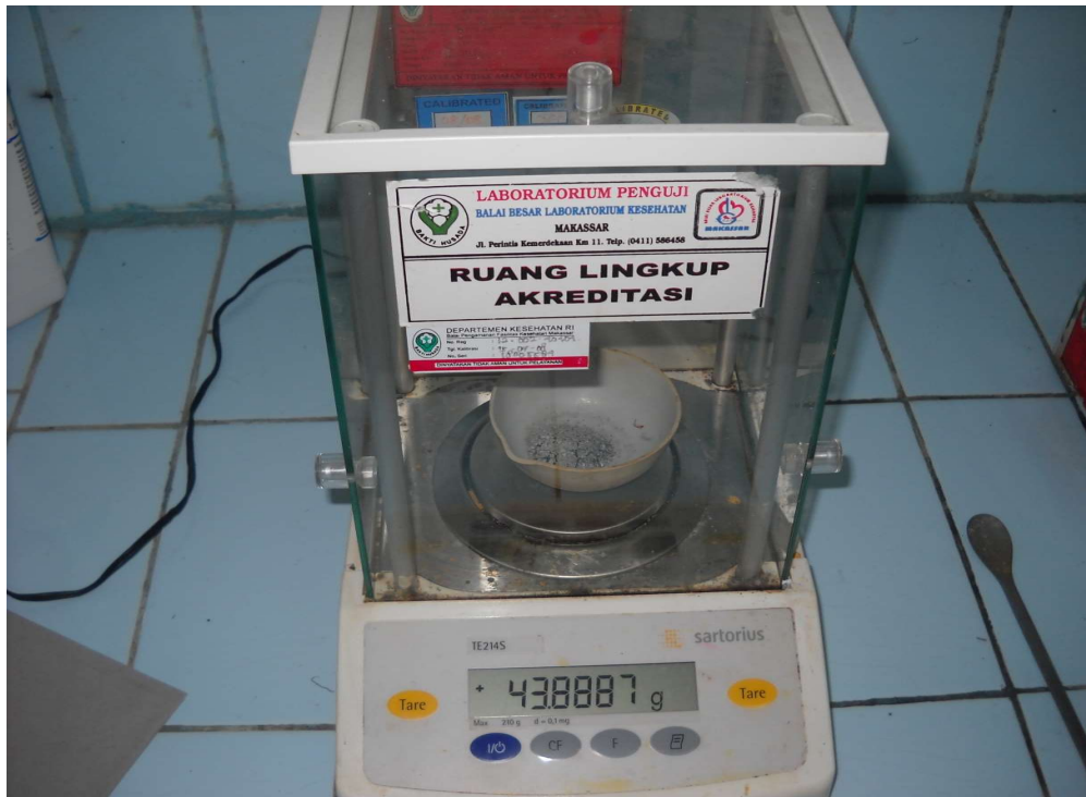
Lampiran 10. Tembangan dan proses penimbangan kadar abu
