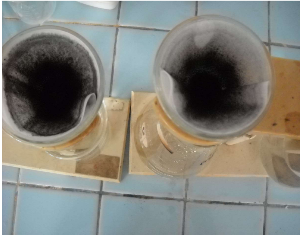
Lampiran 17. Proses penyaringan sitrat kadar sulfur
