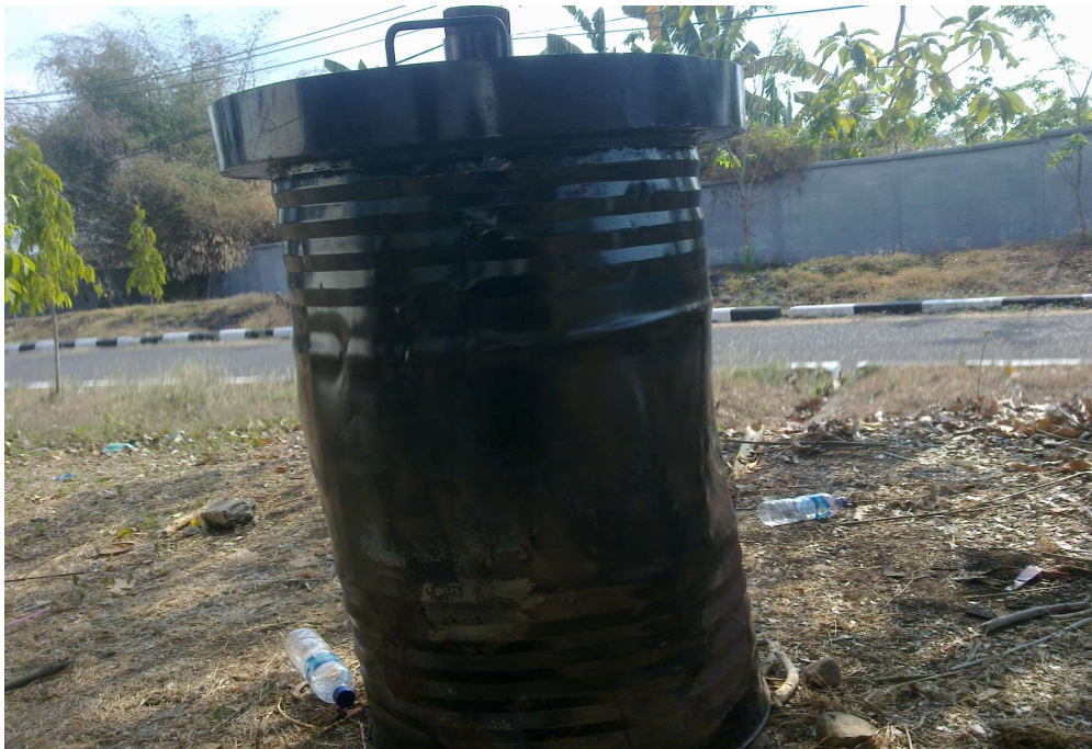
Lampiran 2. Kiln yang digunakan dalam proses pembuatan karbon aktif Tempurung kelapa
