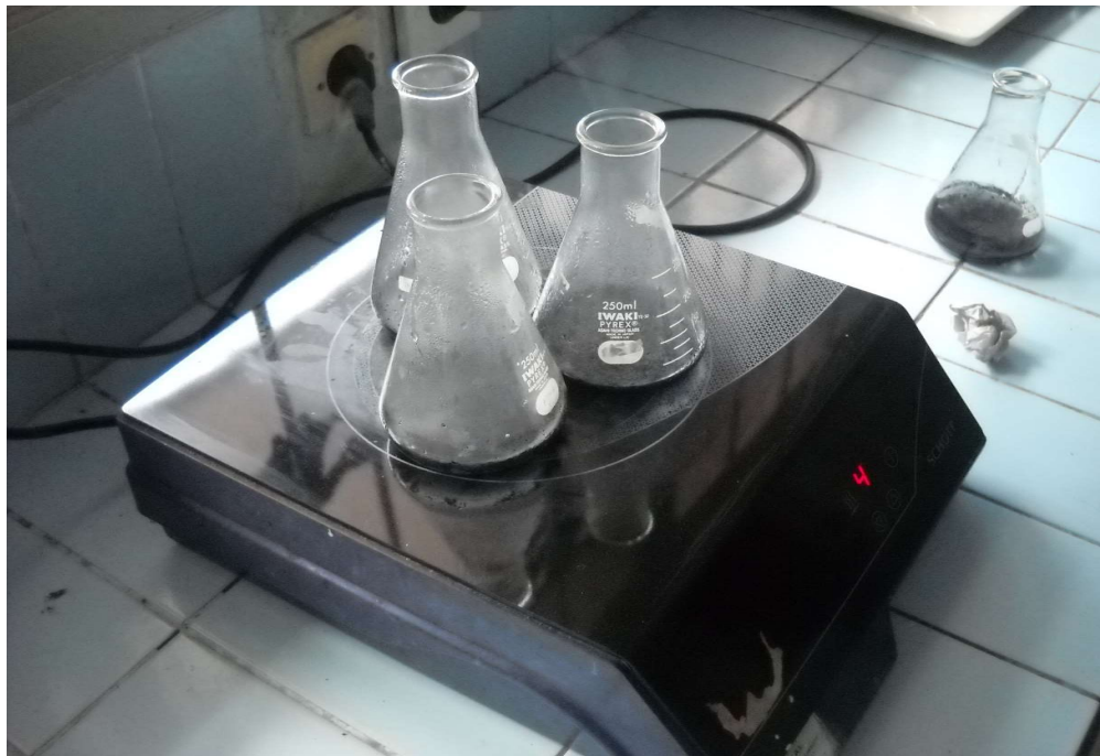
Lampiran 16. Proses pendidihan kadar sulfur dengan campuran HCl pekat dan \text{BaCl}_2 \cdot 2\text{H}_2\text{O}
