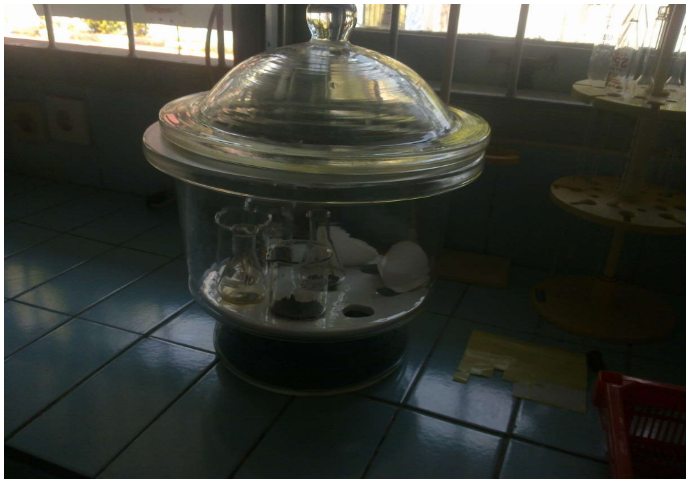
Lampiran 12. Disikator dan beberapa kadar yang sedang didinginkan atau diseterilkan
