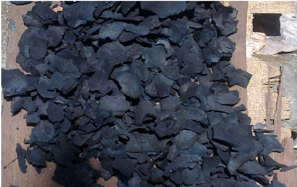
Lampiran 6. Hasil proses karbonisasi tempurung kelapa yang sedang dijemur.
