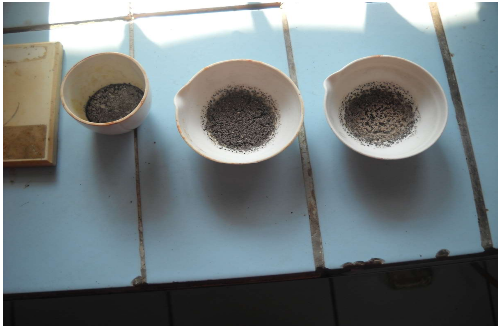
Lampiran 14. Sampel kadar abu yang sudah melalui proses pengabuan
