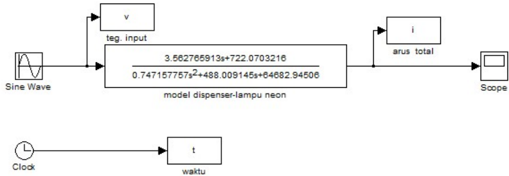
Gambar 4.4. Simulasi beban paralel dispenser dan neon dengan simulink
