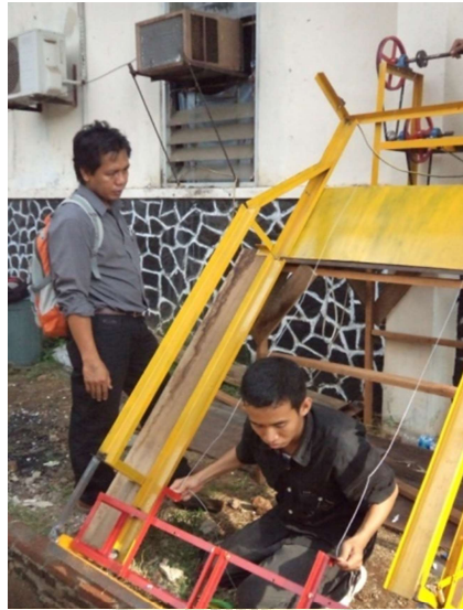
Proses Pemasangan Tali Penarik
