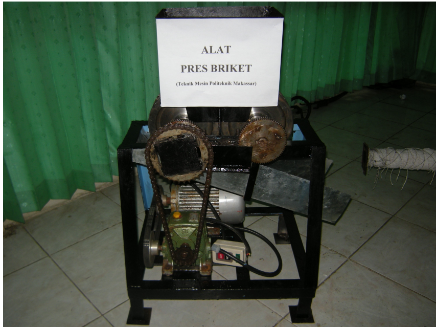
Mesin pencetak briket batubara pada pameran 30 th Teknik Mesin UMI (Universitas Muslim Indonesia)
