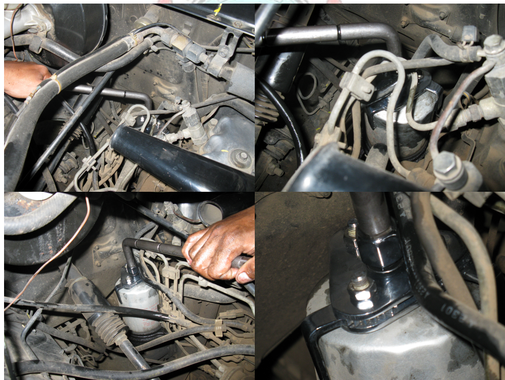
Gambar pembongkaran saringan oli
