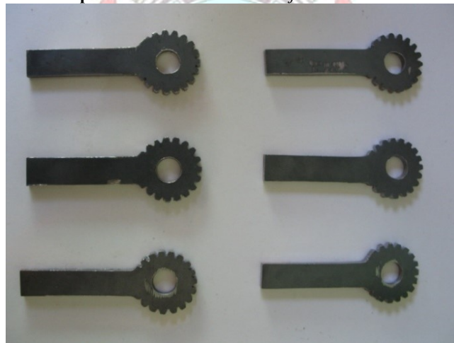
Lampiran 9.a. Gambar benda kerja sebelum dikrom
