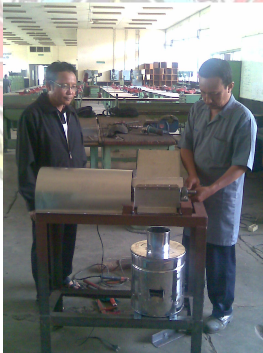
Gambar 8. Proses perakitan setiap komponen pamarut.
