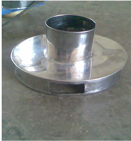
Gambar 3. Penutup tabung pemeras kelapa.
