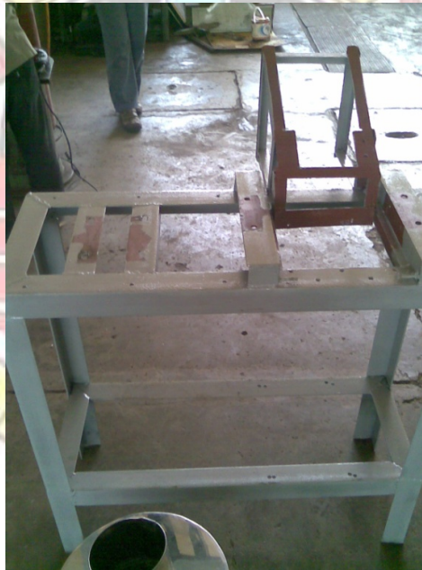
Gambar 4 .Rangka dudukan motor dan pamarut kelapa.
