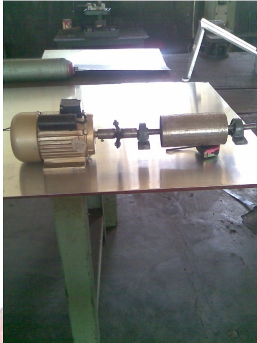
Gambar 5. Motor pamarut yang dikopel dengan poros pamarut kelapa.
