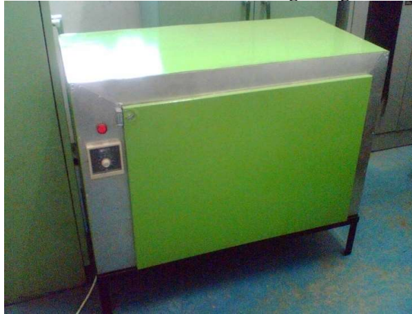
Gambar L.1. Hasil rancang bangun alat pengering putu kacang.
