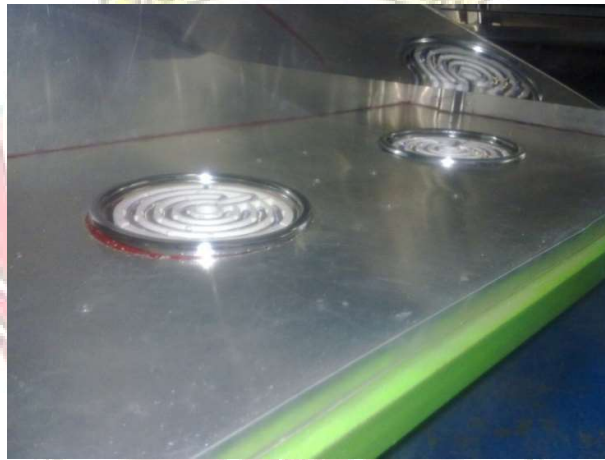
Gambar L.2. Sistem pemanas alat pengering putu kacang.
