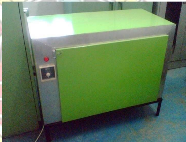
Gambar 4.1 Alat Pengering Putu Kacang kapasitas 16 kg.
