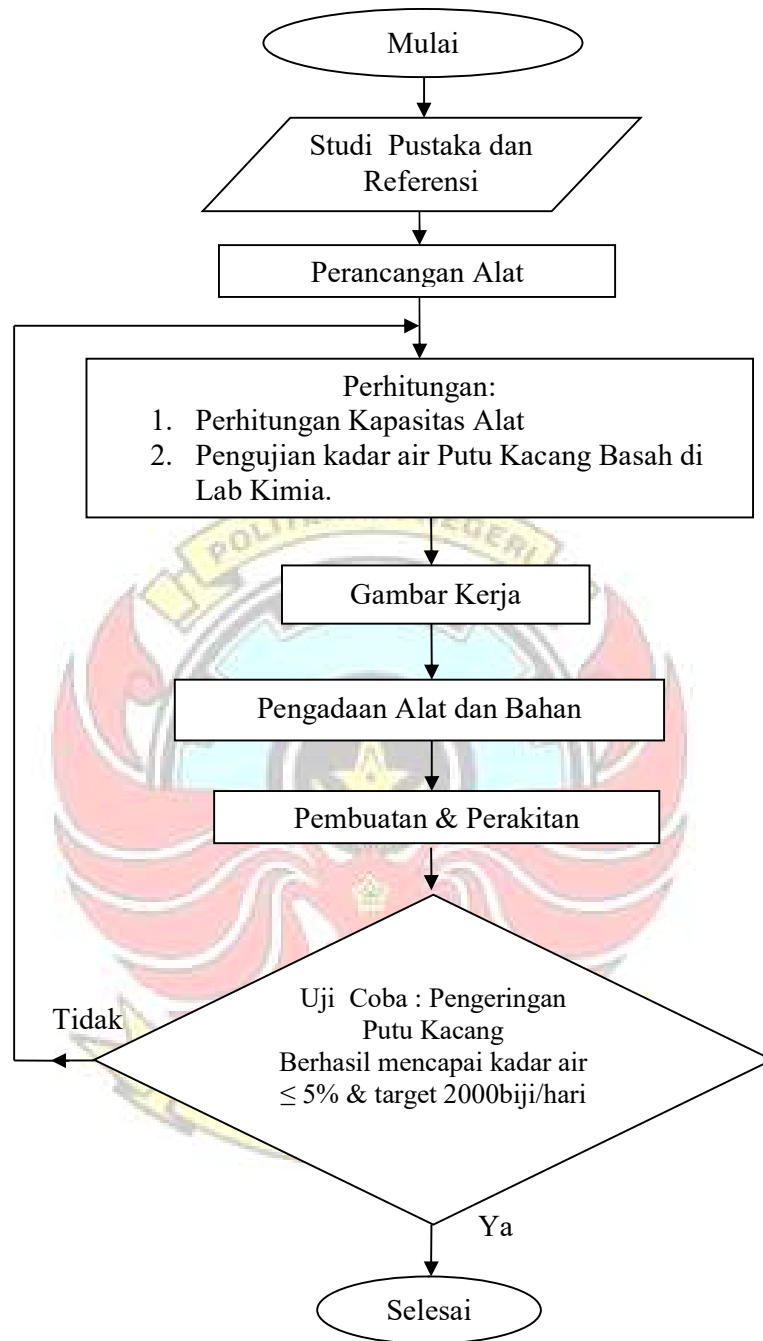
Gambar 3.1 Diagram alir proses rancang bangun alat pengering putu kacang kapasitas 16 kg
