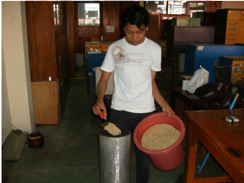
Gambar 16. Seorang mahasiswa memasukkan bahan bakar ke dalam reactor
