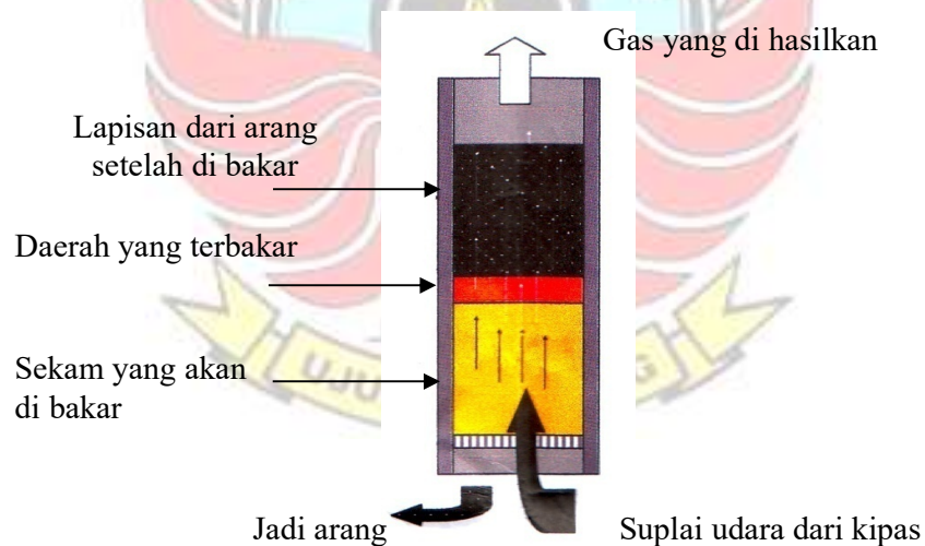
Gambar 1. Prinsip kerja dari daerah pembakaran
