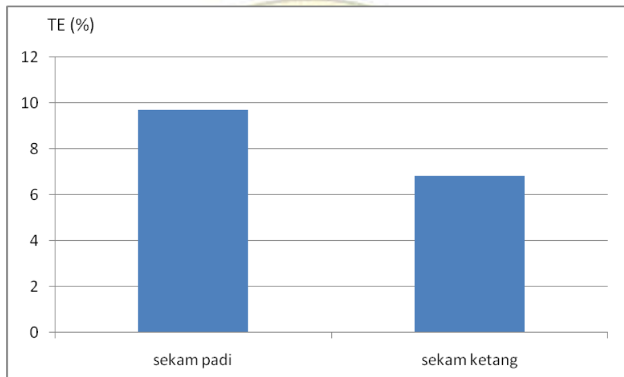
Gambar 5. Grafik perbandingan bahan bakar berdasarkan efisiensi thermal kompor untuk pengujian start dingin
