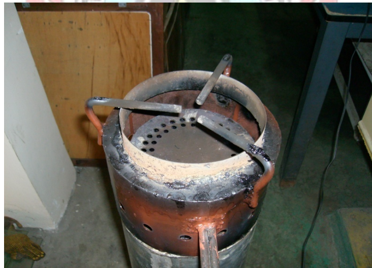
Gambar 20. Sungkup dipasang dibagian atas reactor
