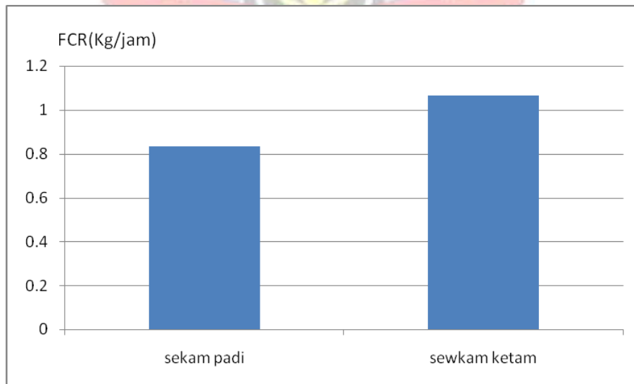
Gambar 9. Grafik perbandingan bahan bakar berdasarkan laju konsumsi bahan bakar (FCR) untuk pengujian start panas
