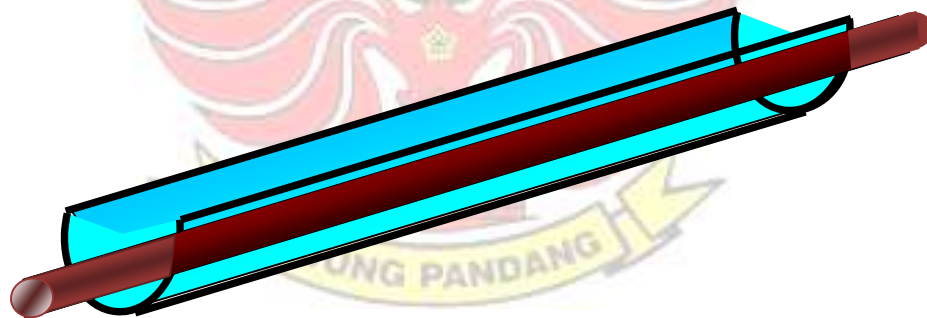
Gambar 2.3. Potongan Saluran konsentrator semi silindris
