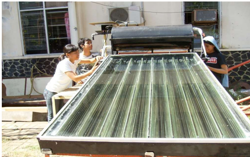
Gambar G.1 Pemanas air tenaga surya dengan kolektor surya konsentrator paralel semi silindris
