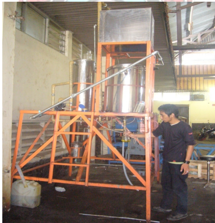
Gambar D-1 Tangki penampungan dan pengendapan
