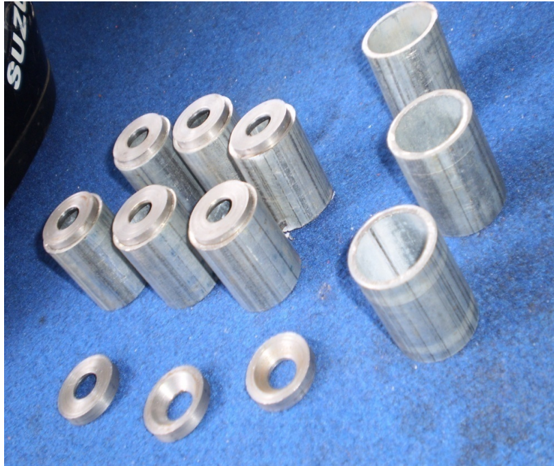
Gambar B-1 Bentuk potongan bagian osilasi dan pelat sekat berbentuk cincin
