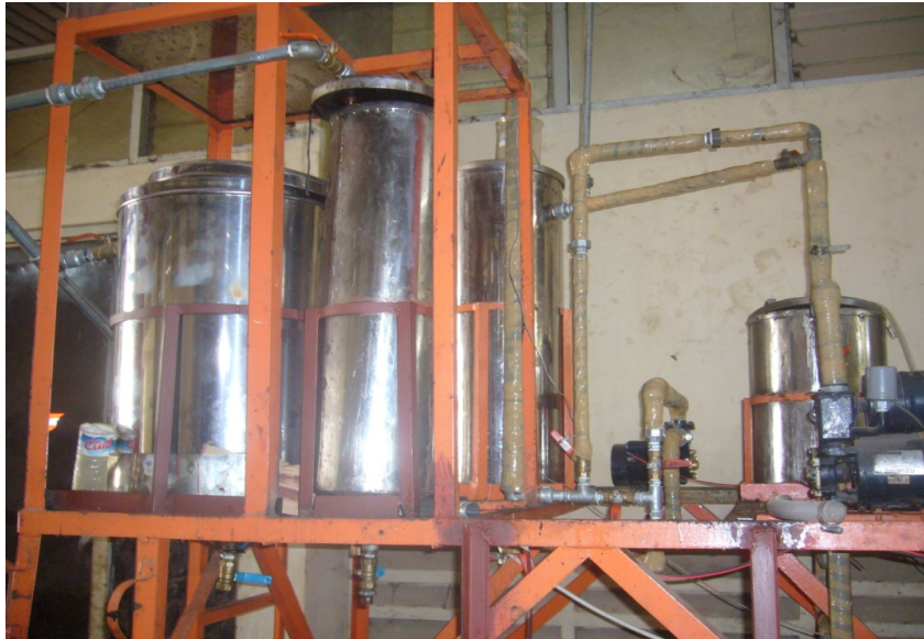
Gambar D-1 Tangki penampungan dan pengendapan
