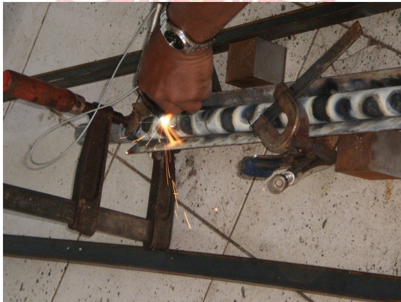
Gambar B-2 Penyambungan reaktor osilasi dengan menggunakan las gas
