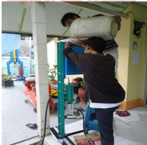
Gambar 30. Mengisi Tangki dengan Oli
