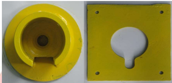
Gambar 8. Hasil Pembubutan alas dan plat pengikat tabung hidrolik.
