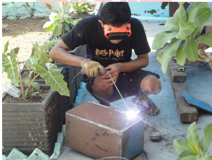
Gambar 28. Pengelasan Tangki Oli
