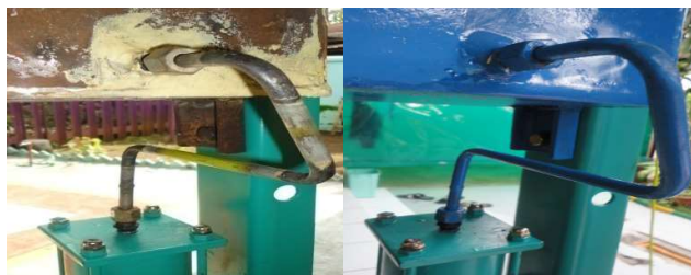
Gambar 13. Pipa penghubung antara tangki oli atas dan bawah
