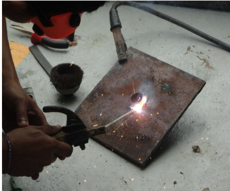
Gambar 29. Pengelasan Tutup Tangki Oli
