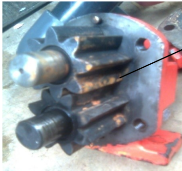
Gambar 3.2 Poros, gir pompa dan rumah pompa bagian depan.
