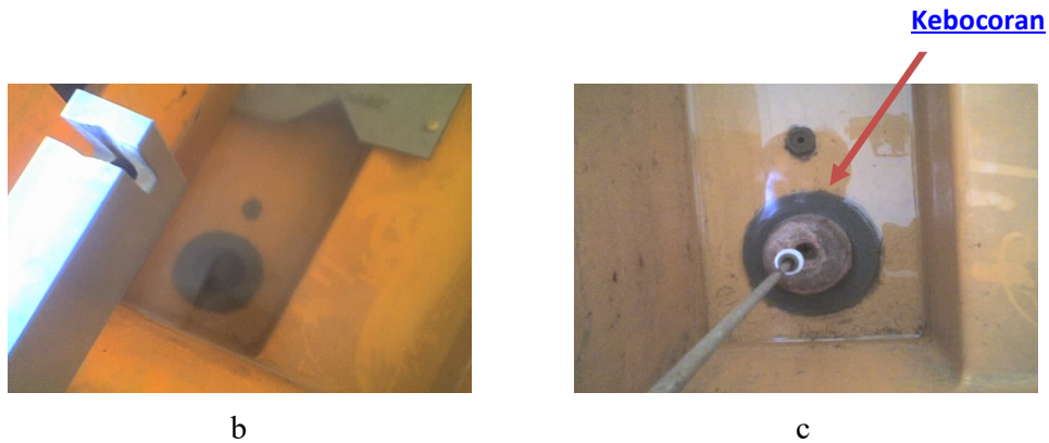
Gambar 3.16 a) Bak penampungan air, b) pengait penutup bak volumetrik, c) Penutup bak volumetric.
