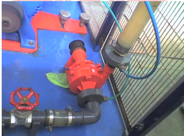
Gambar 3.19 a. Pompa sentrifugal tampak dari samping, b. Pompa sentrifugal dan pipa sisi isap serta sisi tekan.
