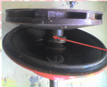
Gambar 3.9 Poros pompa dan impeler.
