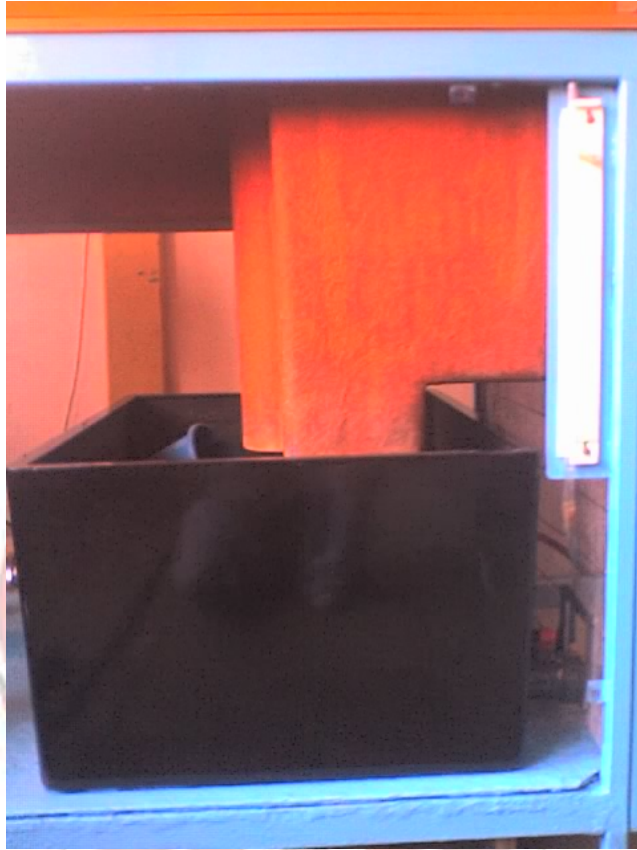
Gambar 3.24. Bak penampung dan bak volumetrik bagian atas.
