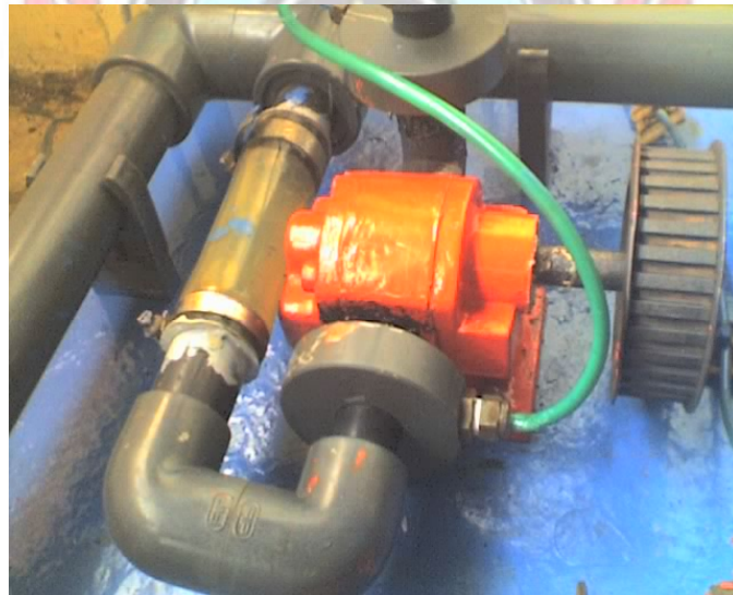
Gambar 3.20 a. Pompa roda gigi tampak dari samping, b. Pompa roda gigi dan pipa sisi isap serta sisi tekan.
