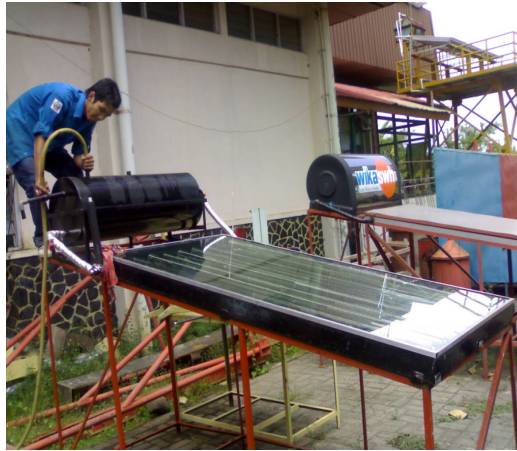
Foto 1. Proses Pengisian Air ke Kolektor
