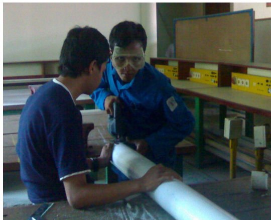
Foto 17. Pemotongan Pipa (alas) Kolektor
