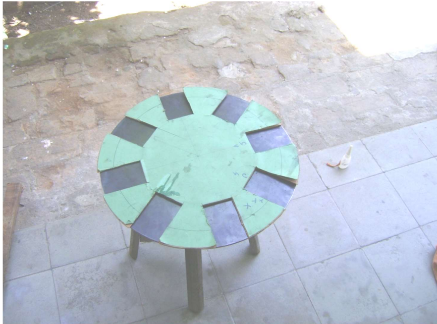
Gambar B.13. Pola peletakan magnet pada rotor
