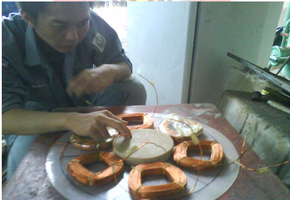
Gambar B.6. Pola peletakan belitan pada stator
