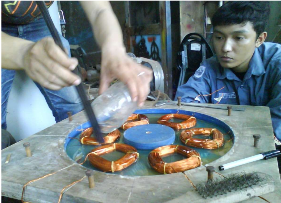
Gambar B.9. Menuangkan campuran fiberglass pada mall cetakan stator
