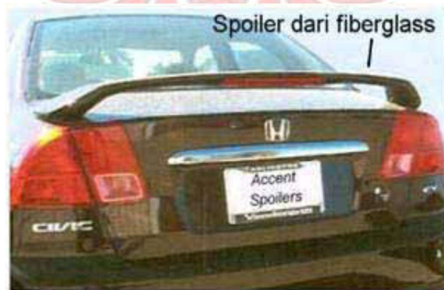
Gambar 9. Komponen bodi mobil ( spoiler ) yang terbuat dari fiberglass
