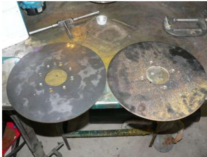
Gambar 39. Plat berbentuk lingkaran sebagai tempat meletakkan magnet
