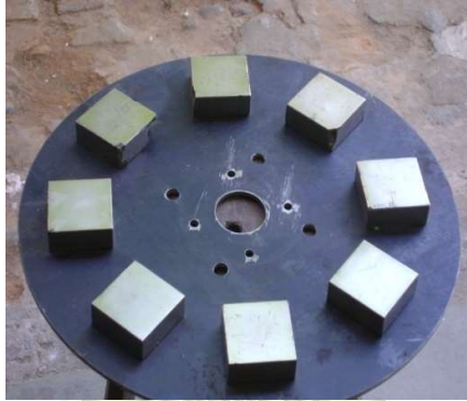
Gambar 41. Magnet yang telah terpasang di atas permukaan plat sesuai dengan pola
