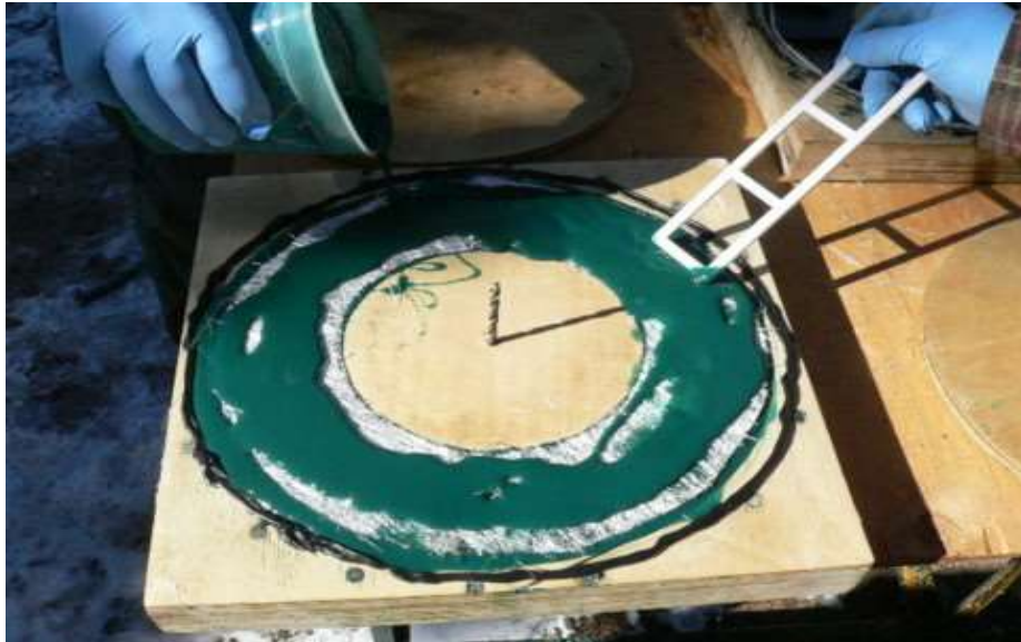
Gambar B.15. Proses pengecoran rotor
