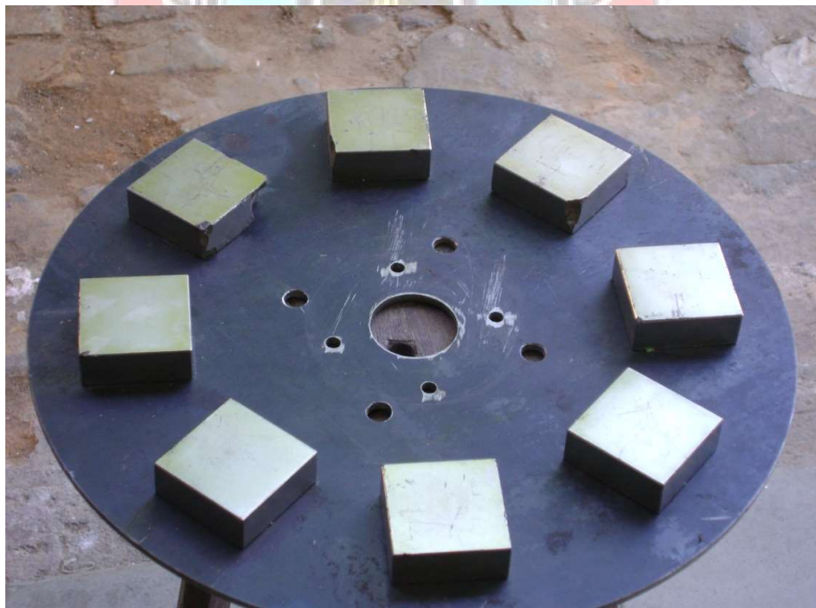
Gambar B.14. Peletakan magnet pada plat
