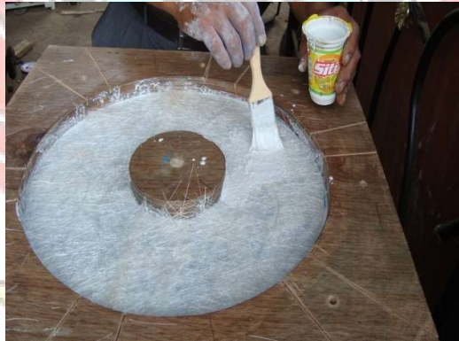
Gambar 30. Menuang cairan fiberglass sebagai dasar cetakan
