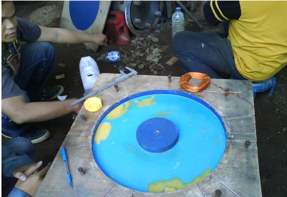
Gambar B.5. Mal cetakan stator
