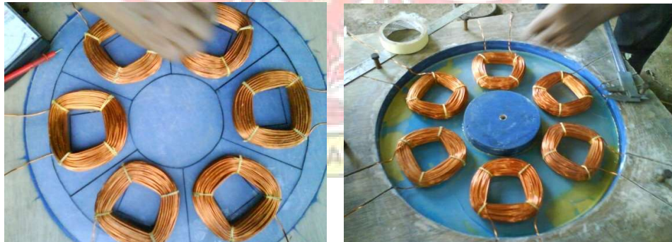
Gambar 27. Mal cetakan stator dengan kumparannya
