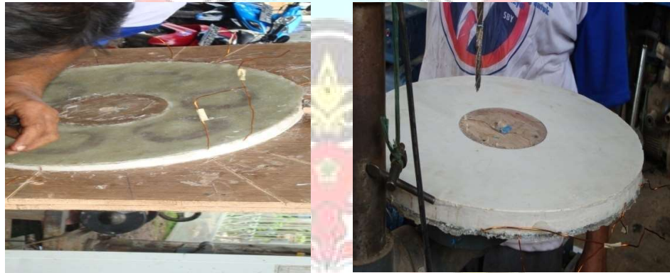
Gambar 32. Melepaskan stator dari mal cetakan
