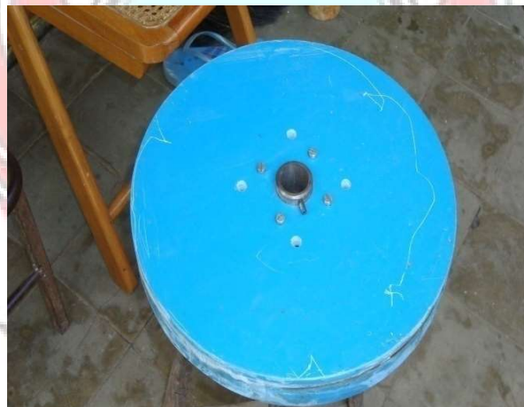
Gambar 43. Rotor setelah dilepaskan dari cetakan
