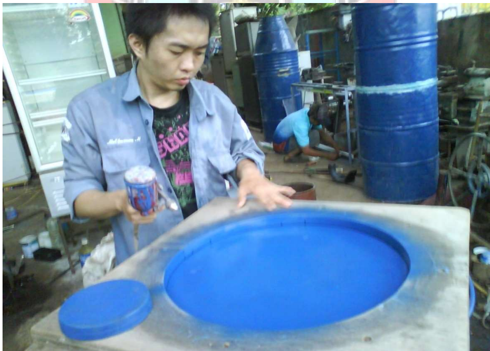
Gambar B.4. Pembuatan mal cetakan stator
