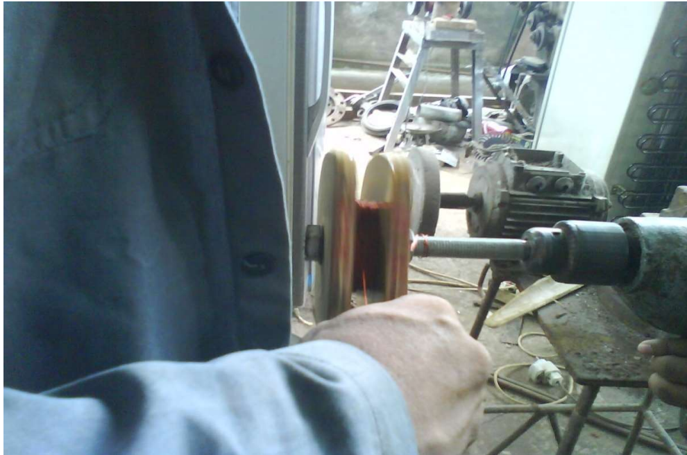
Gambar B.3. Penggulungan belitan stator
