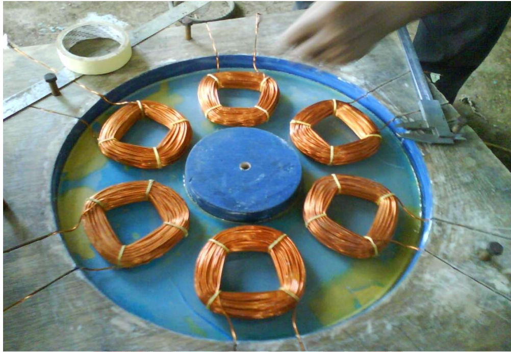
Gambar B.7. Stator siap untuk dicetak
