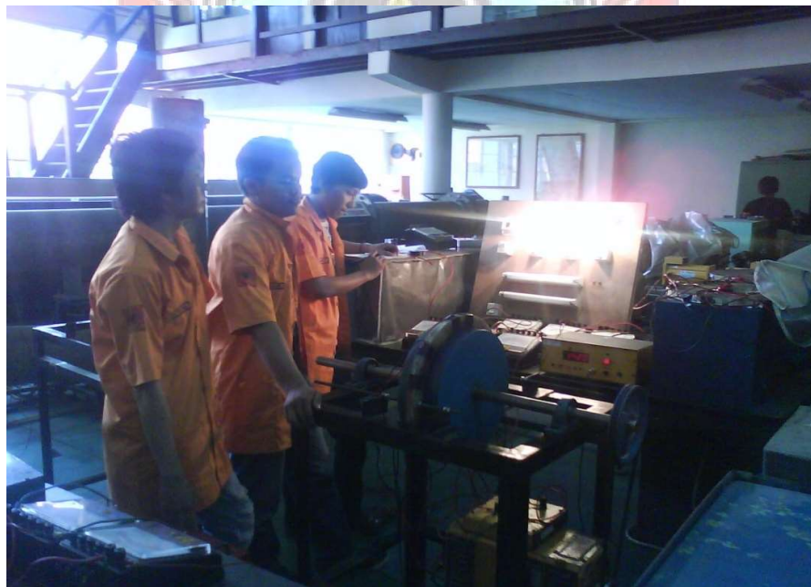
Gambar B.20. Pengujian generator berbeban
