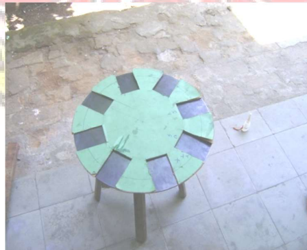
Gambar 40. Patron yang diletakkan di atas plat
