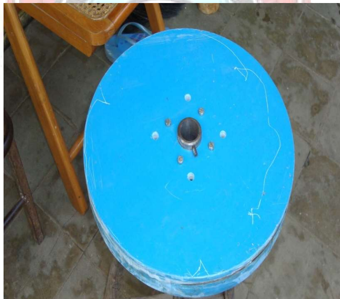
Gambar B.16. Rotor yang didalamnya terdapat magnet
