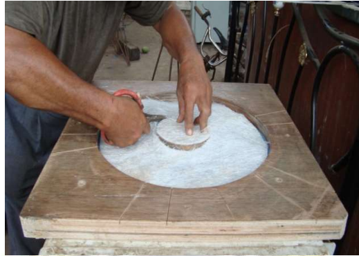
Gambar 28. Menggunting kain serat fiber (Mat)
