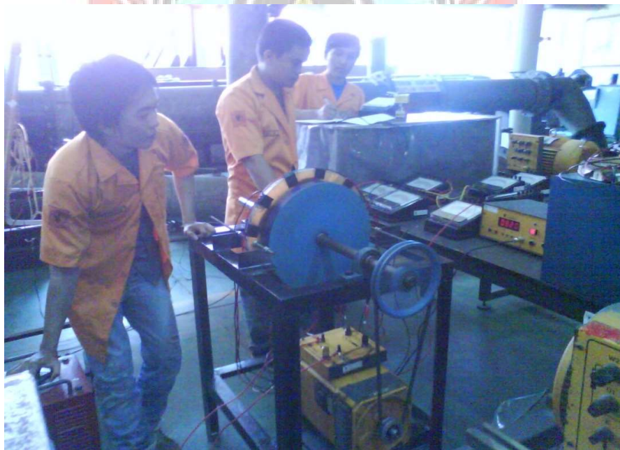
Gambar B.18. Pengujian generator tanpa beban
