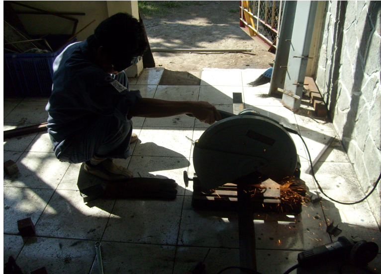
Gambar B.2 Pemotongan kaki rangka dudukan bioaktivator
