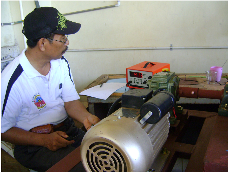
Gambar B.8 Pengujian kontrol dan mekanisme pengaduk pada beban kosong
