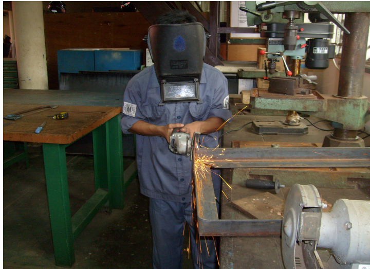
Gambar B.4 Merapikan hasil las pada rangka motor
