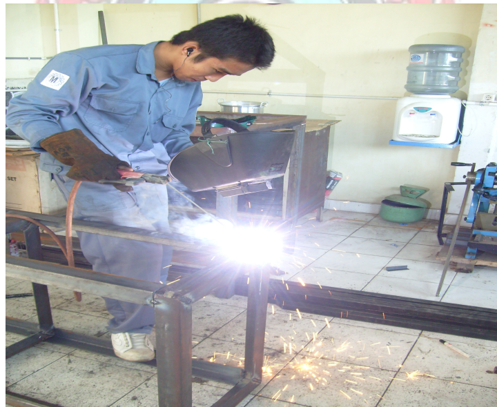
Gambar B.5 Pengelasan pada rangka dudukan reducer dan motor
