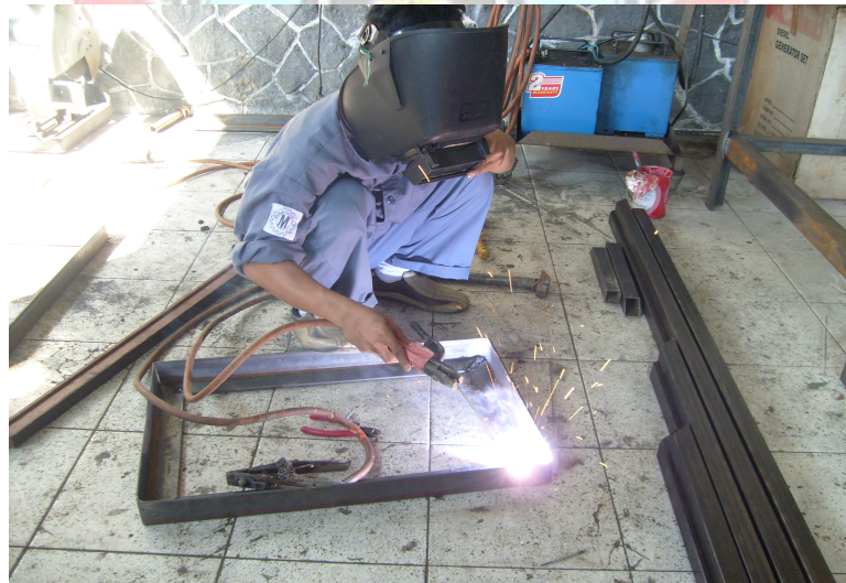
Gambar B.3 Pengelasan rangka penahan atas pada dudukan motor
