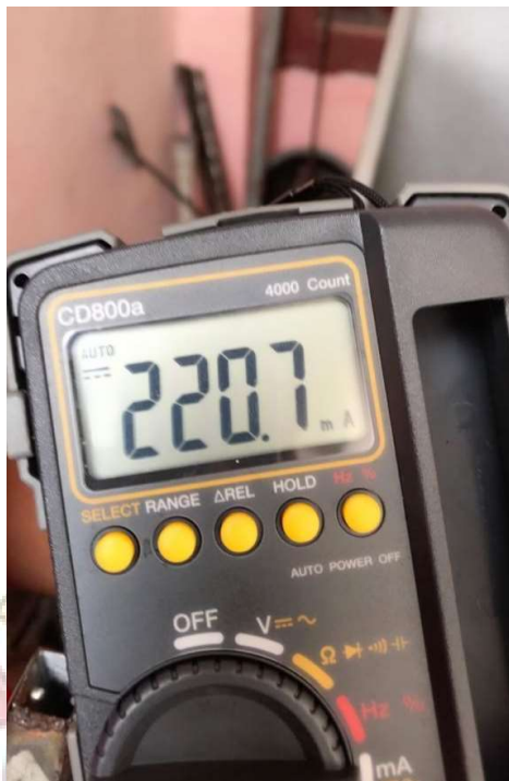
Lampiran 7 Pengukuran Arus Lampu Utama
