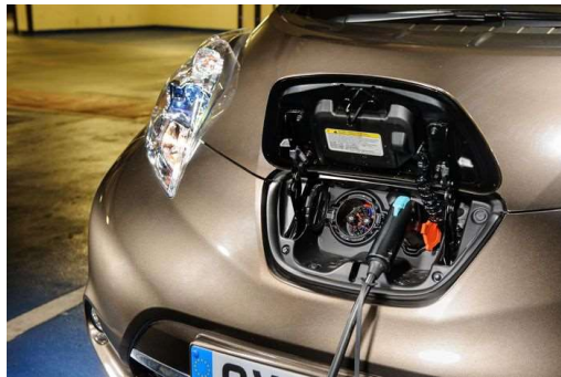
Gambar 2. 1 Input Charger pada Mobil Listrik (Sumber : Herdianto, 2019)
