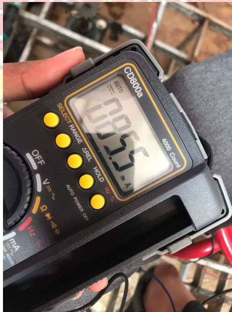
Lampiran 8 Pengukuran Arus Lampu Sein (Kiri)
