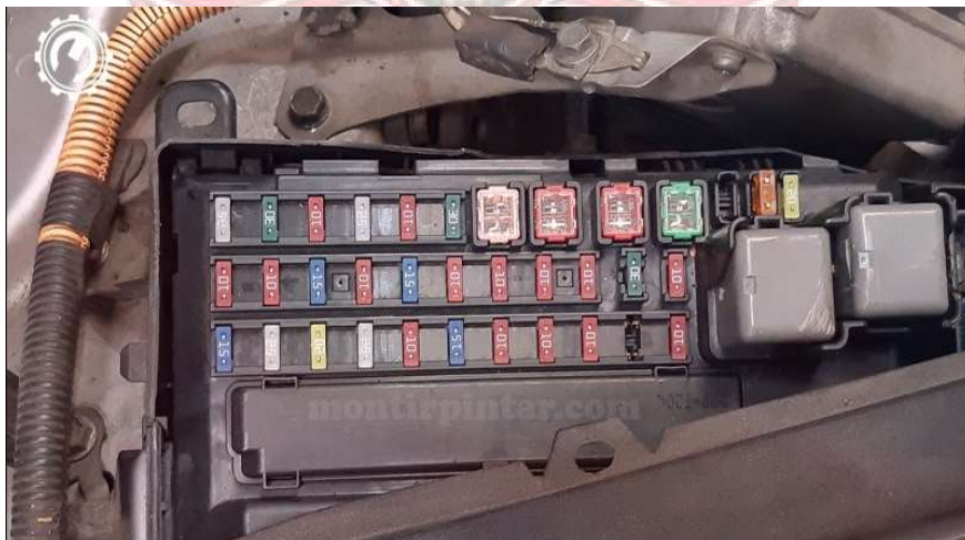
Gambar 2. 8 Kotak Sekring (Sumber : Montirpedia, 2020)
