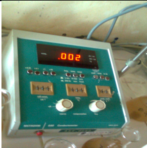
Gambar 3.4. Alat ukur konduktifitas larutan polutan (konduktormeter)
