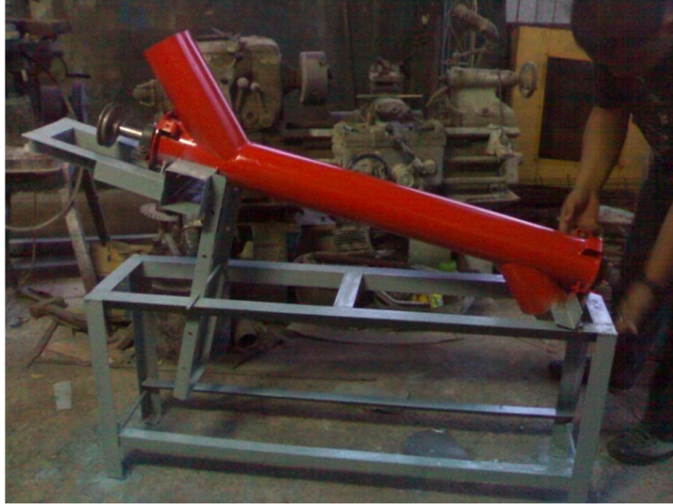
Gambar 3.6 Proses pengecatan turbin ulir
