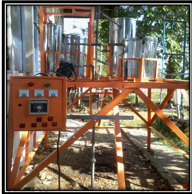
Lampiran A -9. Gambar hasil perakitan alat produksi biodiesel yang belum di isolasi
