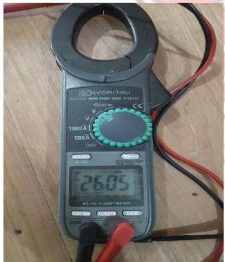
Hasil Pengukuran Tegangan Input di Driver Kondisi Motor Diam di Box Dryer
