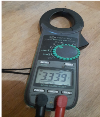
Hasil Pengukuran Tegangan di Micro limit switch 1 Solar Dryer
