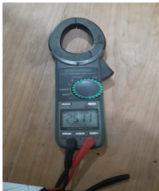
Hasil Pengukuran Tegangan Output di Driver Kondisi Motor Berputar di Box Dryer
