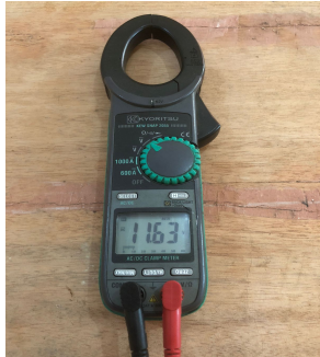
Hasil Pengukuran Tegangan Pada saat tidak berbeban di Solar Dryer
