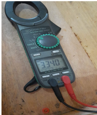
Hasil Pengukuran Tegangan di Micro limit switch 2 Solar Dryer
