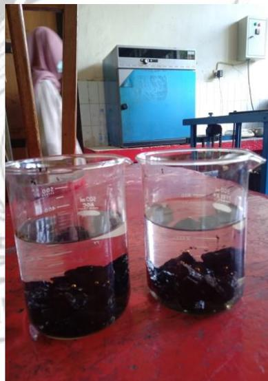
Memindahkan sampel kedalam gelas ukur dan merendamnya selama 16-18 jam lalu mengamati apakah kelekatan aspal >95% atau <95%, dan pada pengujian ini aspal melekat > 95 % terhadap agregat
