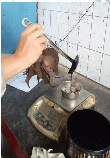
Menuang aspal cair kedalam sampel agregat yang telah bersuhu ruang lalu mengaduk rata hingga seluruh agregat terselimuti dan memasukkannya kedalam oven selama 2 jam
