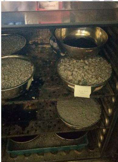
Mengoven agregat yang telah dicuci selama 24 jam
