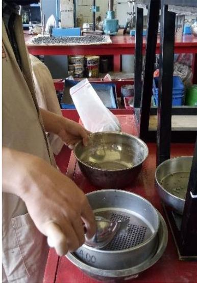
Menyaring agregat untuk mendapatkan sampel yang lolos saringan No. 4
