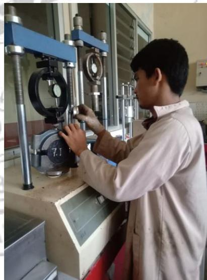
Memasang benda uji (briket) ke mesin *Marshall* dan memulai pengujian menggunakan mesin *Marshall*.
