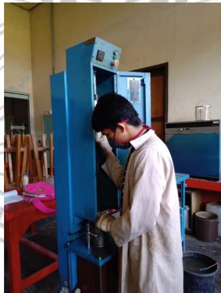
Memasang mold dengan posisi yang aman dan sesuai dengan mesin penumbuk briket, lalu tiap sisi briket ditumbuk 75 kali
