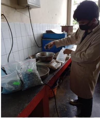
Menimbang sampel agregat yang lolos saringan no. 4
