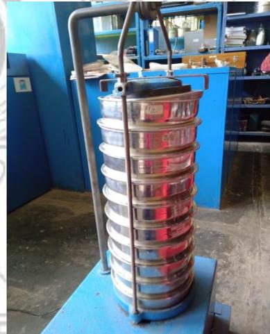
Melakukan gradasi per fraksi menggunakan mesin pengantar selama  $\pm 15$  menit per fraksi
