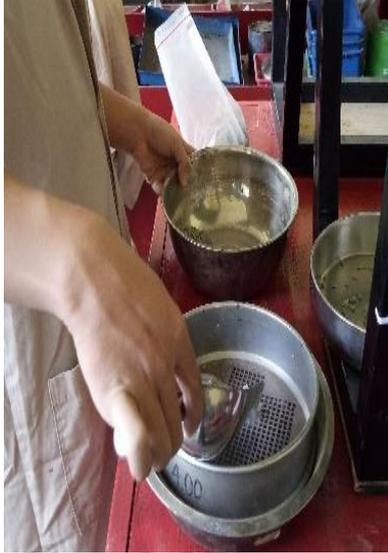
Menyaring sampel agregat untuk mengambil sampel yang lolos saringan no. 4
