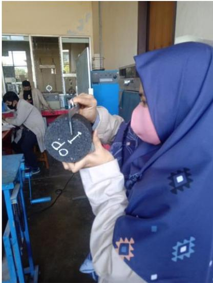
Mengukur tebal setiap benda uji (briquet) pada 3 sisinya yang berbeda dan mencatat hasilnya
