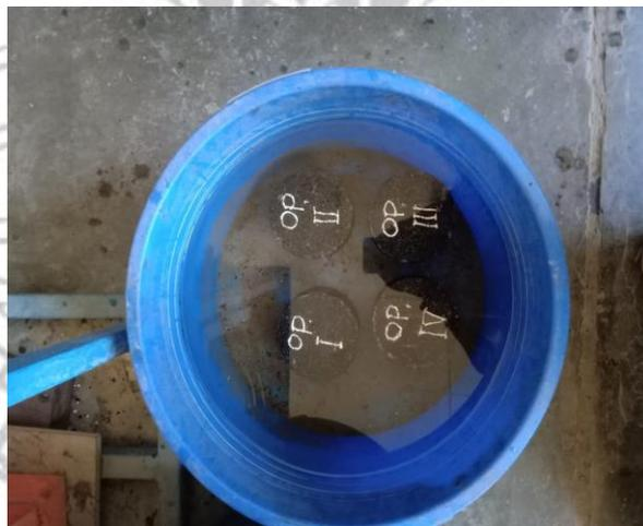
Merendam setiap benda uji (briquet) ke dalam air selama  $\pm 24$  jam sebelum dilakukan penimbangan berat dalam air dan SSD.
