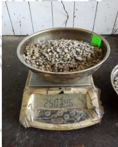
menimbang agregat yang telah dioven untuk digradasi sesuai fraksinya masing-masing
