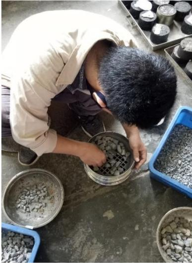
Menyaring sampel agregat menggunakan saringan yang telah ditentukan di SNI
