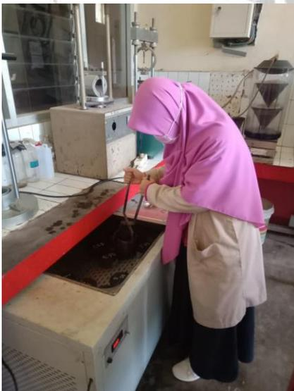
Merendam benda uji (briket) ke dalam *waterbath* dengan suhu  $60^{\circ}$  selama 30-40 menit sebelum di uji dengan alat uji *Marshall*
