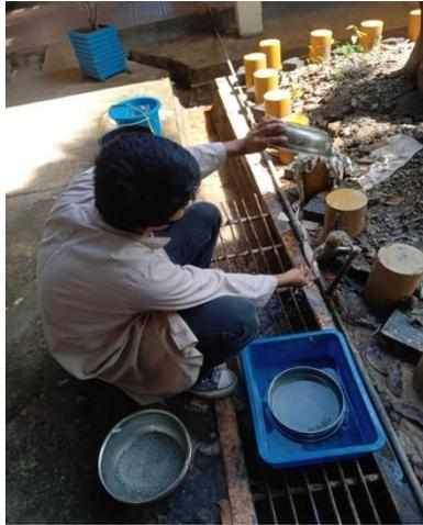
Menyaring agregat yang telah dipecahkan dalam air menggunakan saringan no.20, lalu memasukkannya kedalam oven hingga beratnya tetap
