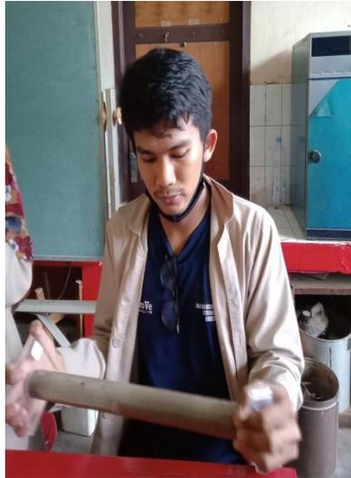
Menggoyangkan botol secara horizontal dengan kecepatan konstan selama 90 kali
