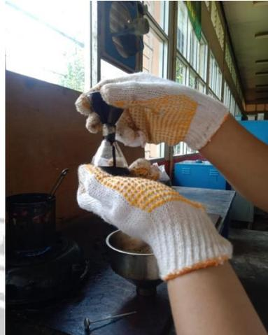
Mengisi piknometer dengan aspal cair  $\frac{3}{4}$  bagian pikno
