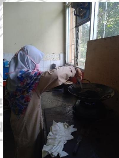
Mengaduk aspal + agregat + filler hingga seluruh permukaan terselimuti aspal secara menyeluruh
