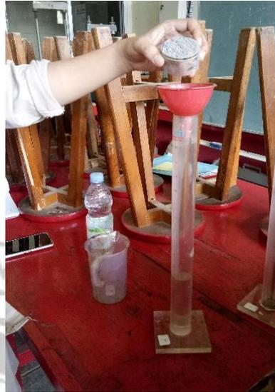
Menuang sampel kedalam botol yang telah diisi air hingga skala 5
