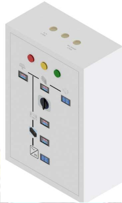
Gambar 3. 6 Rancangan Modul Pengujian Hybrid PLTS-GENSET pada daerah terpencil.
