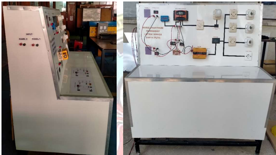
Gambar 4.19 Modul Praktikum Pembangkit Listrik Tenaga Surya
