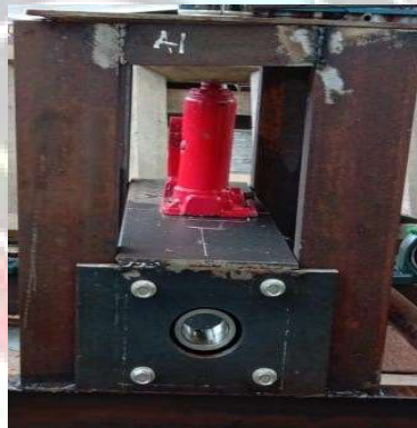
Gambar 3.4. Pemasangan Dongkrak/Hydraulic Jack
