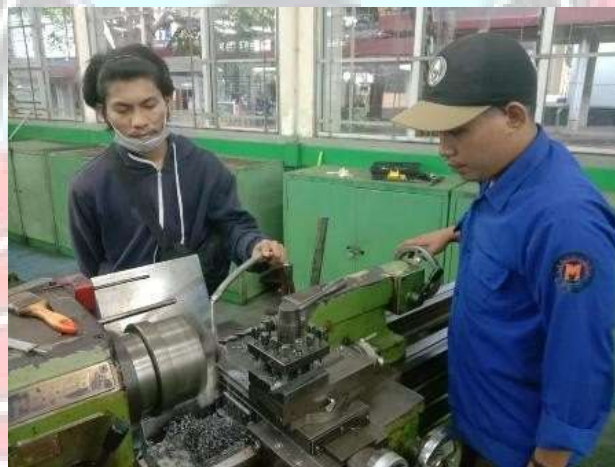
Membuat Lubang Pada Besi Assental
