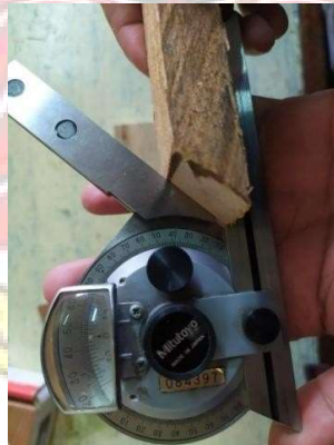
Pengukuran hasil potong diagonal menggunakan bevel
