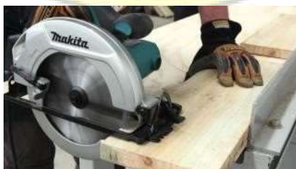
Gambar 2.2 Pemotongan Kayu dengan Mesin Circular Saw Sumber: Bukalapak.com
