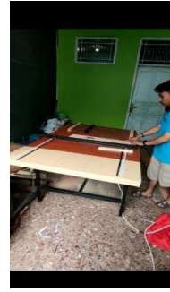
Pemotongan kayu secara rip cut
