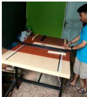
Gambar 4.2 Proses Pemotongan Secara Rip Cut
