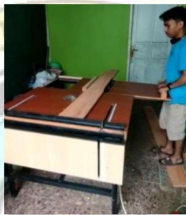
Gambar 4.1 Proses Pemotongan Secara Cross cut
