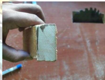
Hasil pemotongan diagonal ( 45^\circ )
