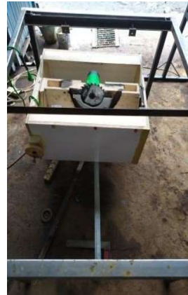
Pemasangan box mesin ke rangka meja
