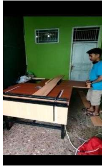
Pemotongan kayu secara cross cut
