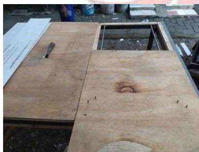
Pemasangan meja geser, meja tetap kerangka
