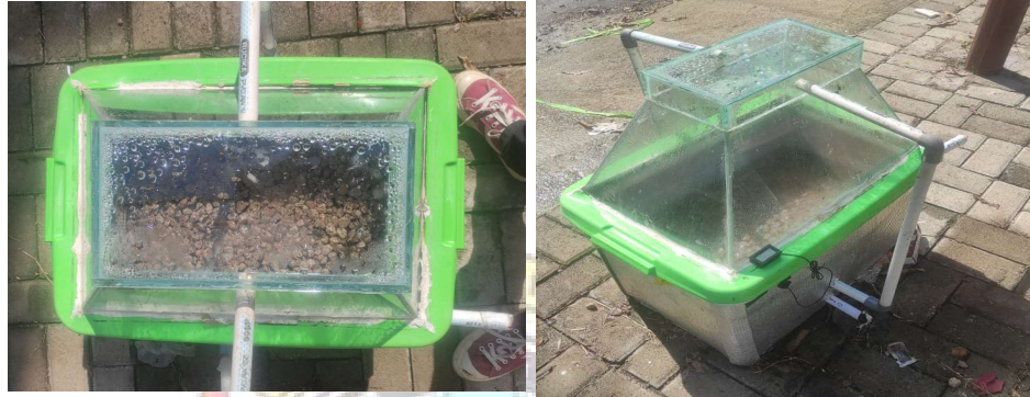
Gambar 4.1 Hasil rancang bangun destilator energi matahari dengan heat absorber .
