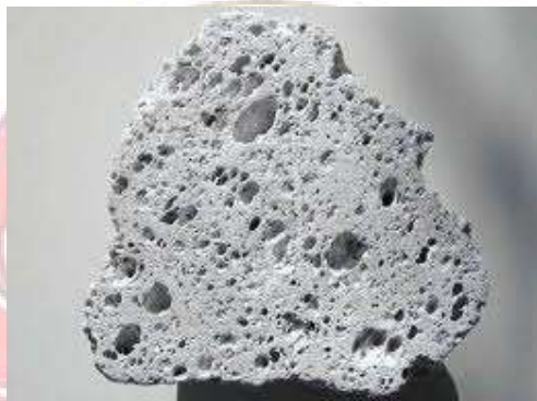
Gambar 2.4 Struktur pori dari batu apung
