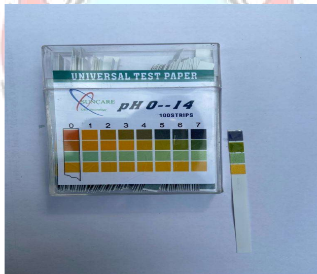
Hasil pengujian pH air hasil destilasi tanpa heat absorber menggunakan kertas lakmus.
