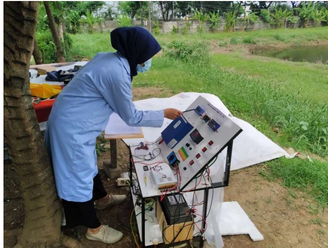
Gambar 10. Proses Pengecekan Sistem Saklar Alih
