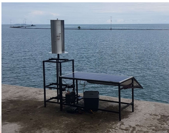
Gambar 4.1 Hasil Rancang Bangun Alat Pendingin ikan untuk digunakan di kapal nelayan
