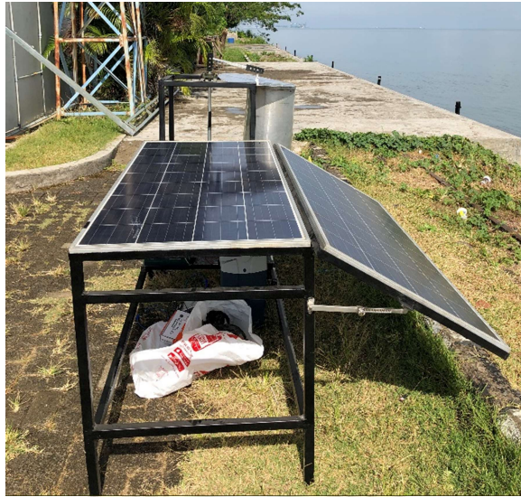
Gambar 4.3 Hasil Rancang Bangun Alat Pendingin ikan untuk digunakan di kapal nelayan
