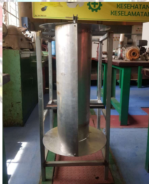
Gambar 4.4 Hasil Rancang Bangun Turbin Angin dengan model yang dilipat
