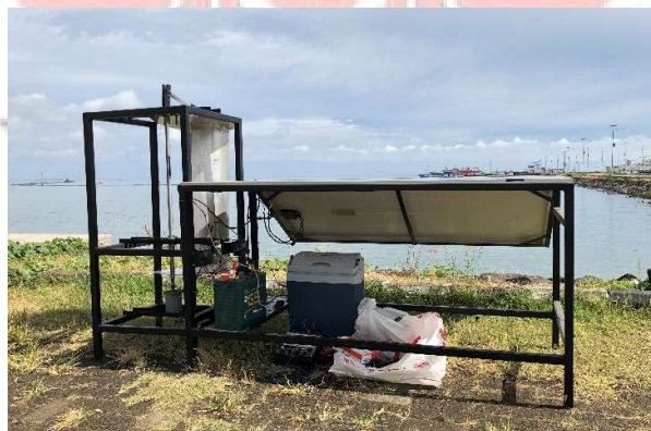
Gambar 4.2 Hasil Rancang Bangun Alat Pendingin ikan untuk digunakan di kapal nelayan
