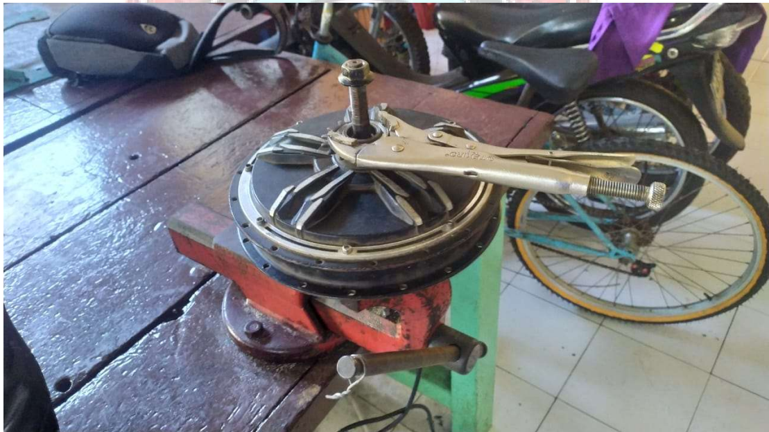
Foto proses pembongkaran motor listrik
