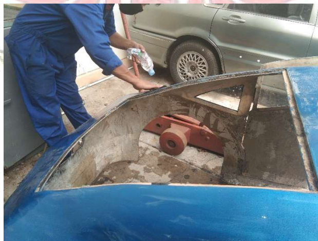
Gambar 4.5 Proses Pendempulan Bodi Mobil Listrik
