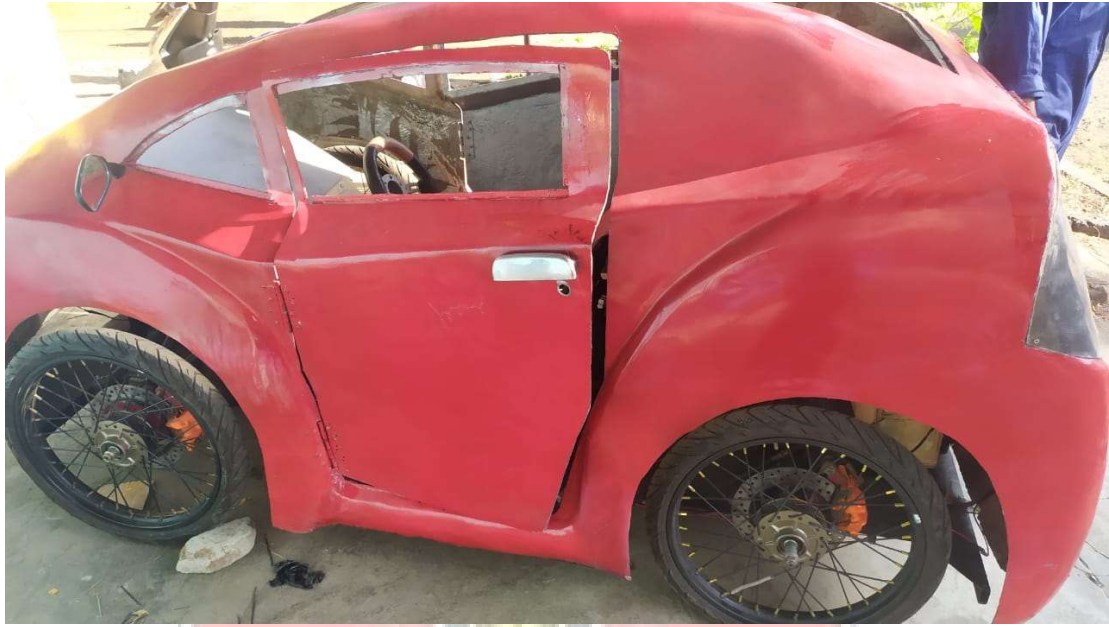
Foto pemasangan body mobil listrik
