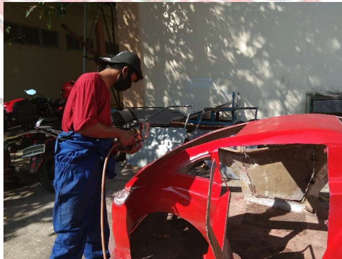
Gambar 4.7 Pengecetan Body Mobil Listrik
