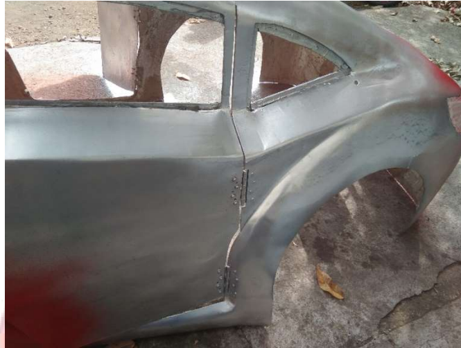
Gambar 4.6 Pengecetan Dasar Body Mobil Listrik
