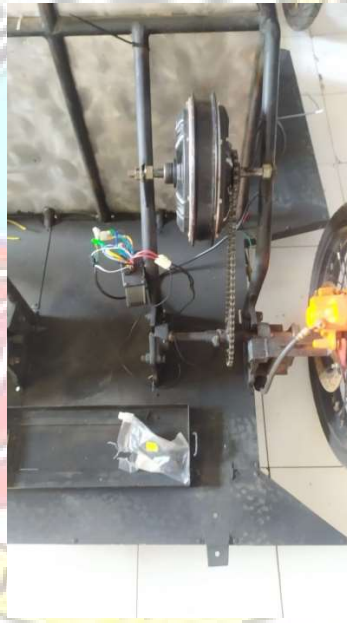
Foto pemasangan motor bldc ke rangkai mobil
