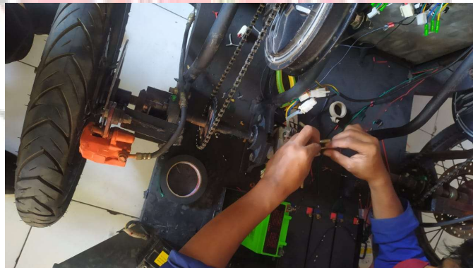
Hasil Dari Perakitan Baterai, Voltase Sebesar 48 V.
