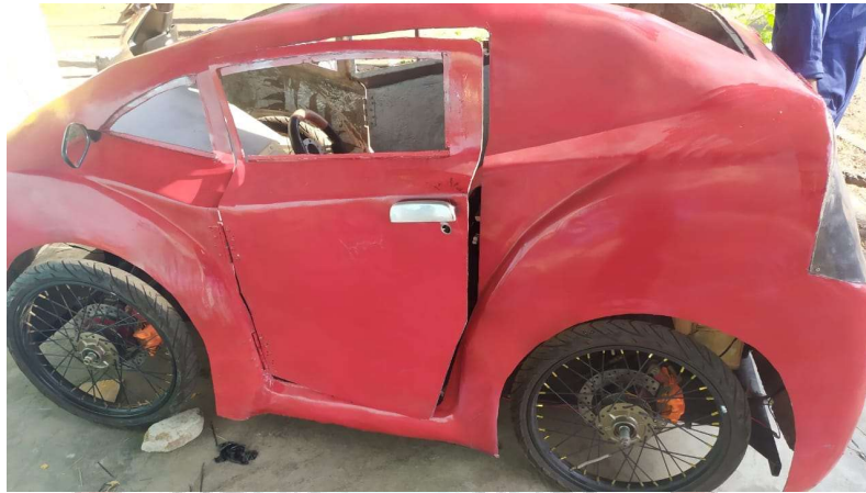
Gambar 4.8 pemasangan body mobil listrik
