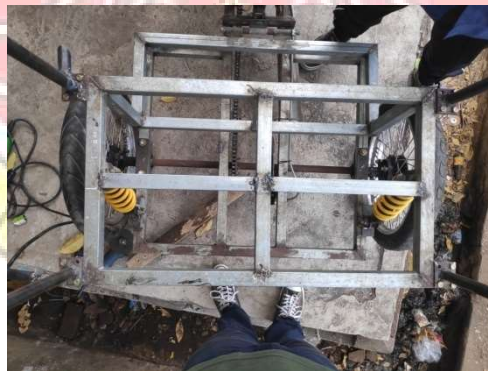
Gambar 4.24 Pemasangan Rangka Bodi ada Chasis Sepeda Motor
