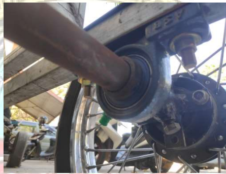
Gambar 4.6 Pemasangan Bearing Duduk Di Poros Dan Swing Arm
