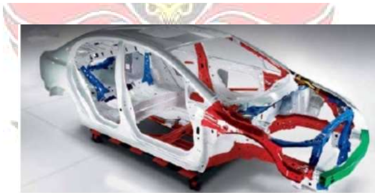
Gambar 2.7 Konstruksi Menyatu (Monocoque Bodi)
