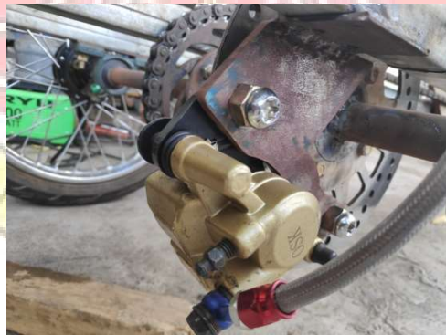
Gambar 4.10 Pemasangan Caliper Rem Belakang
