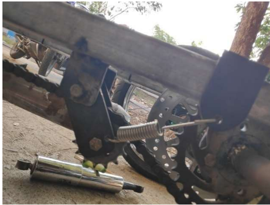
Gambar 4.9 Pemasangan Tensioner Rantai
