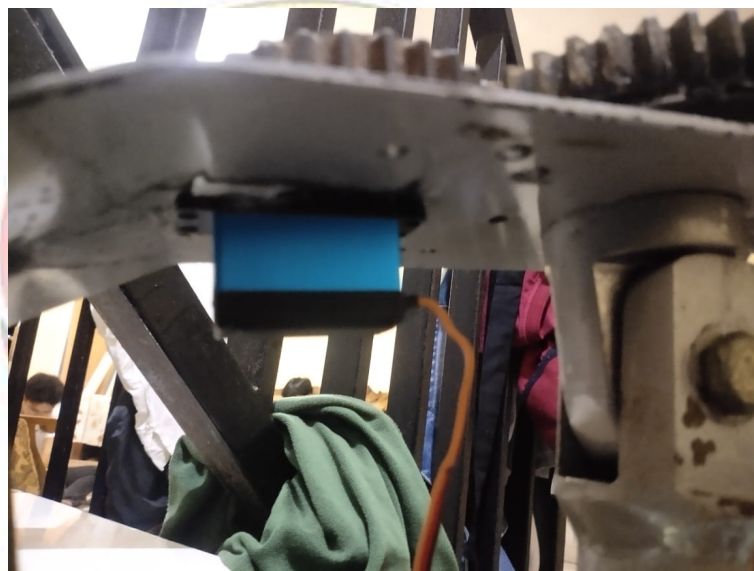
Gambar 4. 2 Penggantian Pergerakan Kiri-kanan dengan Motor Servo
