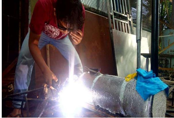
Gambar 3 Proses pengelasan boiler drum pada rangka alat
