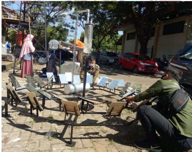
Gambar 2. Proses pengaturan pantulan radiasi cermin di fokuskan pada boiler
