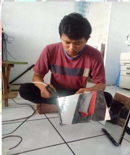
Gambar 4. Proses pengeleman cermin pada rangka cermin
