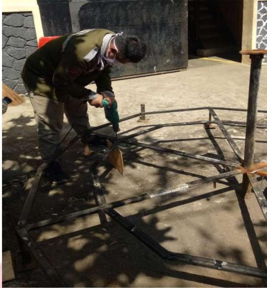
Gambar 1. Proses pengeboran pada rangka alat
