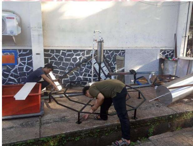
Gambar 2. Proses pengecatan pada rangka alat
