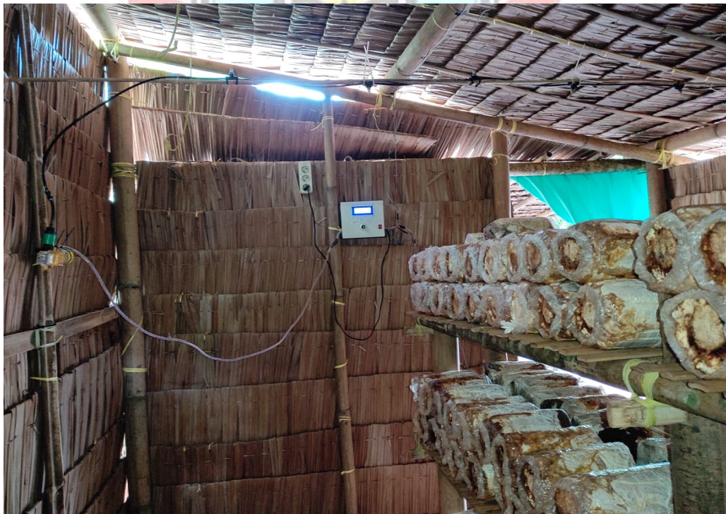
Gambar L.18 Posisi alat pada kumbung, box Raspberry Pi dan Relay
