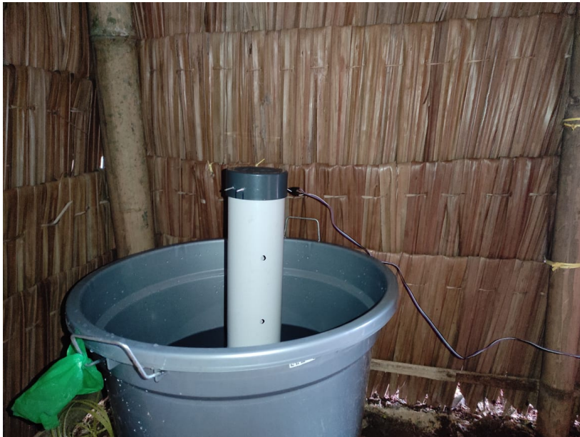
Gambar 4.5 HC-SR04 dan wadah penampungan air.
