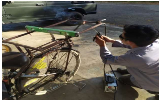
Gambar 6 Pembuatan Rangka Panel Surya
