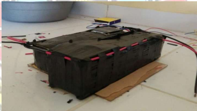
Gambar 4.6 Rangkaian Baterai 48V
