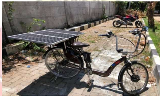
Gambar 10 Proses pengisian baterai dengan Panel Surya
