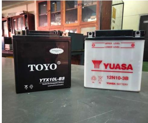
Gambar 4.9 Akumulator kering (kiri), akumulator basah (kanan)
