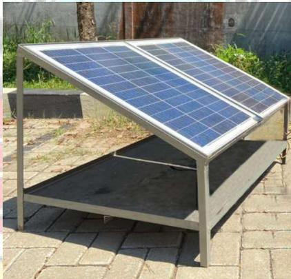
Gambar 4.1 Hasil rancangan rangka panel surya
