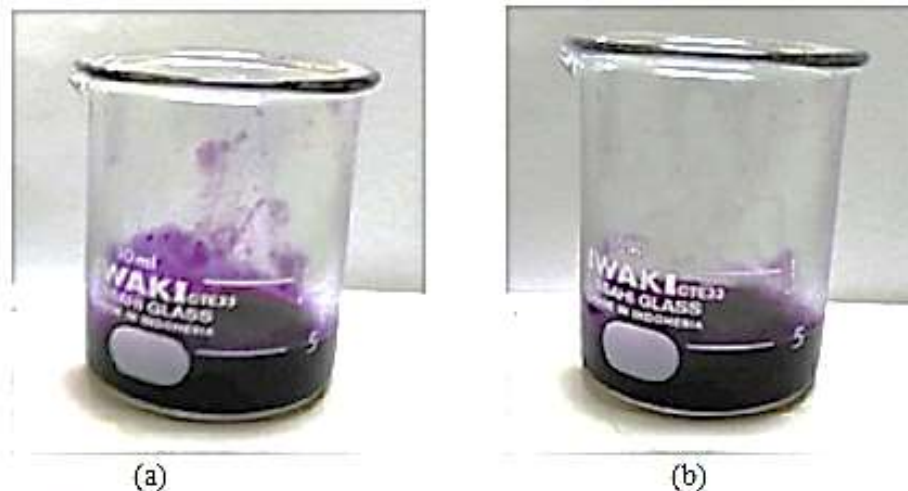
Gambar 1. Ekstrak pigmen antosianin kubis merah hasil ekstraksi (a) metode maserasi sederhana dan (b) metode maserasi-sonikasi.
