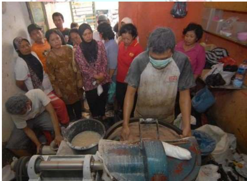
Gambar 2.2 Mesin Pengaduk Adonan Bakso
