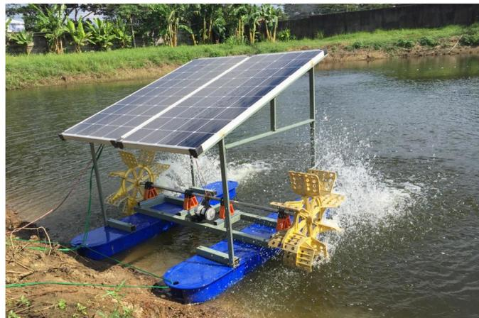
Gambar 3.1 Konstruksi Mekanik Aerator
