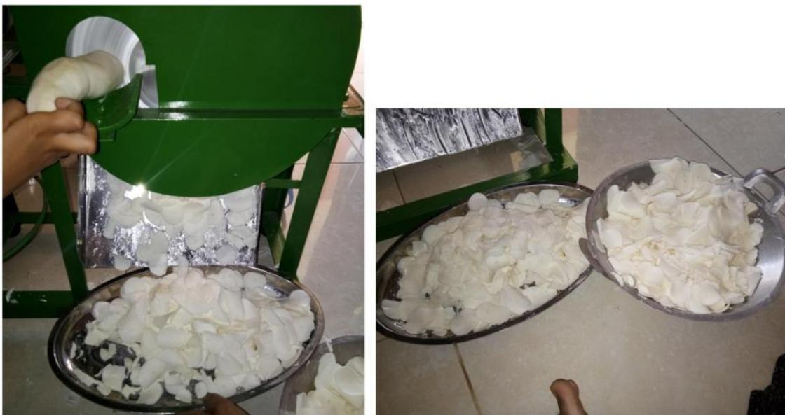
Gambar 2. Pemotongan Singkong Menjadi Potongan Keripik
