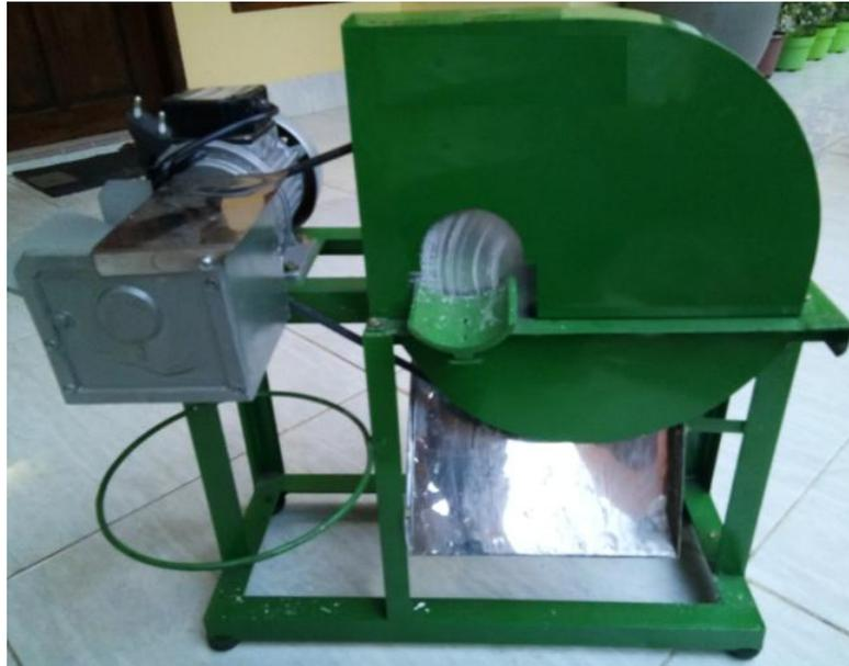
Gambar 1. Mesin Potong Keripik Singkong
