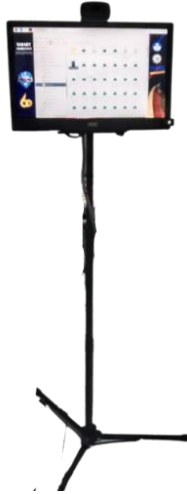
Gambar 5. Hasil Tampilan Keseluruhan Sistem Pengukuran Suhu Tubuh
