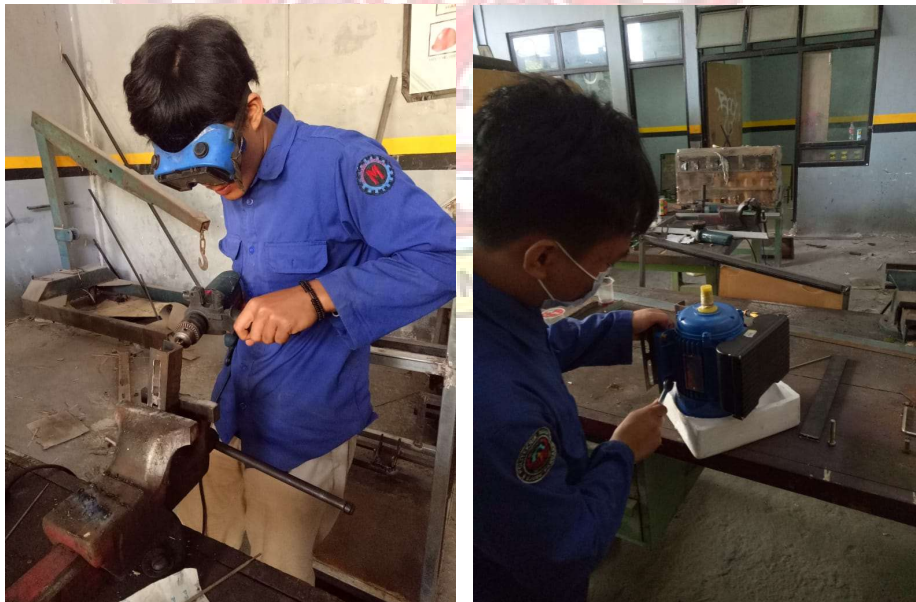
Gambar 5. Pembuatan lubang dan pemasanganudukan dynamo
