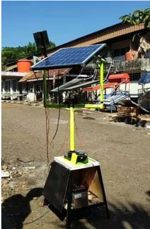
Gambar 6. Alat uji sel surya dengan penjejak matahari
