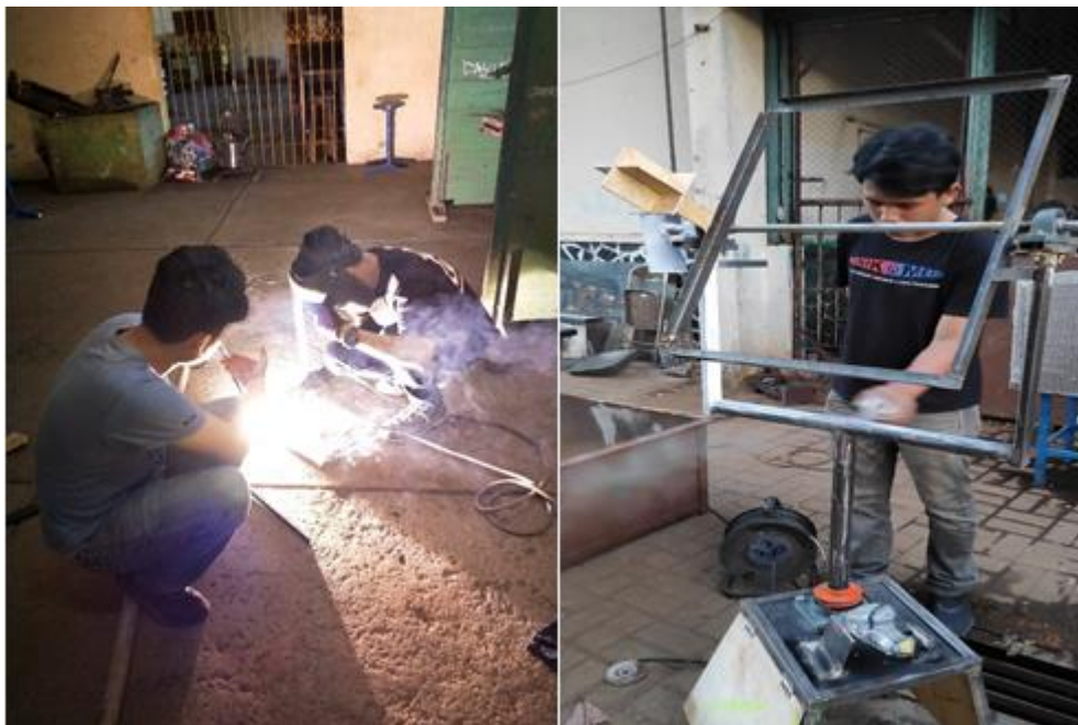
Gambar 3. Pembuatan rangkaian mekanis penjejak surya
