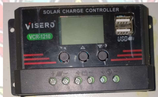
Gambar 3.4 Solar Charger Controller Sumber : Dokumen pribadi
