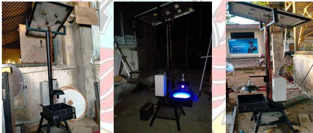
Gambar 4.1 Alat hybrid termoelektrik generator dengan panel surya untuk membasmi hama pada perkebunan bawang merah
